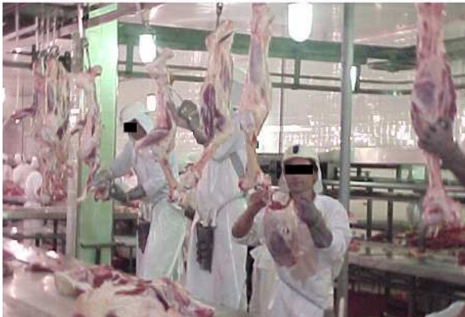
Figura 9 Funcionários na separação dos diferentes tipos de carne em elevação nas roldanas. O presente posto exige do trabalhador durante a jornada de trabalho, postura em pé com lateralização e flexão de tronco, flexão de cotovelo, abdução e flexão de ombro e movimentos repetitivos de punho.
