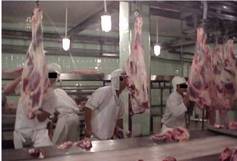
Figura 8 Funcionários na separação dos diferentes tipos de carne em elevação nas roldanas. O presente posto exige do trabalhador durante a jornada de trabalho, postura em pé com lateralização e flexão de tronco, flexão de cotovelo, abdução de ombro e movimentos repetitivos de punho.
