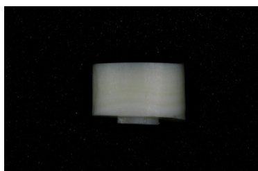
Fig. 10 – Corpo de prova após a realização do teste push-out
