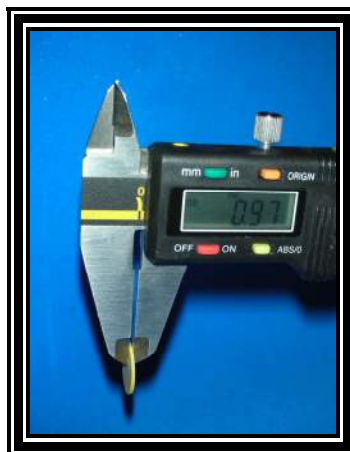
FOTOGRAFIA 7 - Paquímetro digital realizando a medição da espessura em mm de uma região do corpo-de-prova.
