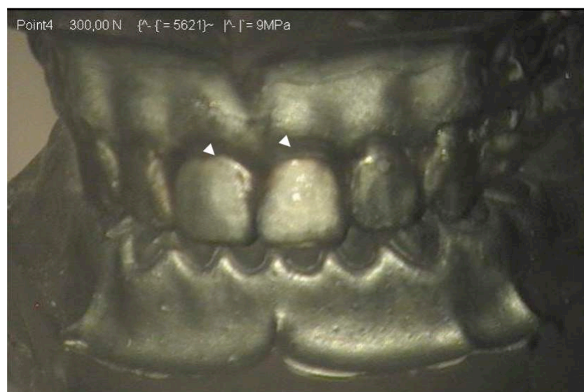
FIGURA 15 – Tensões observadas somente nos pontos cervicais, observar setas.
