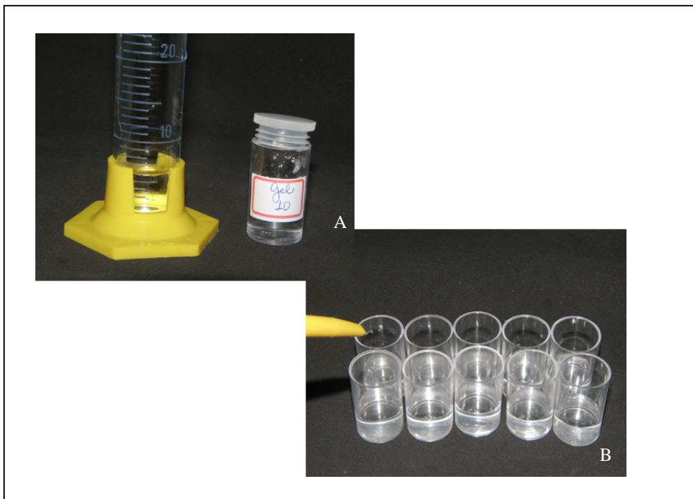
Figura 2 - Armazenamento dos corpos-de-prova. A: proveta com 6 mL de água deionizada. B: preenchimento dos frascos com água deionizada
