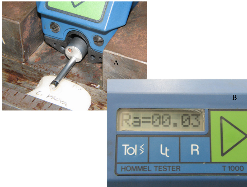
Figura 3- Rugosímetro. A: leitura da rugosidade dos corpos-de-prova. B: valor da rugosidade de um dos corpos-de-prova
