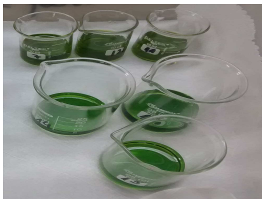
Figura 15 Preparo do extrato de Banisteriopsis gardneriana para determinação do teor de sólidos solúveis.
