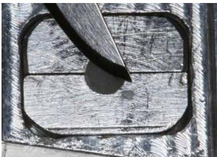
Figura 12 - Remoção dos excessos de resina
