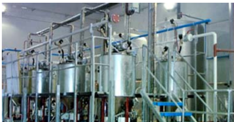
Figura 4. Unidades com capacidade para 1000 L/h
