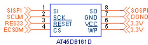
Figura 22. Interface com memória flash serial
