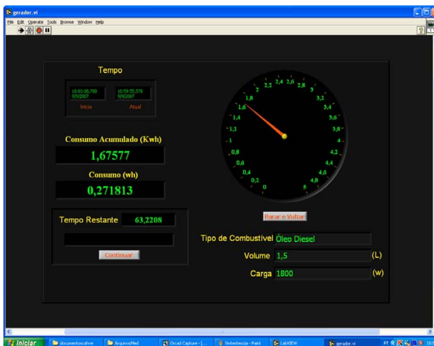
Figura 11. Tela operacional (PC) de resultados de quantidades de energia produzida (acumulada e instantânea) e tempo decorrido
