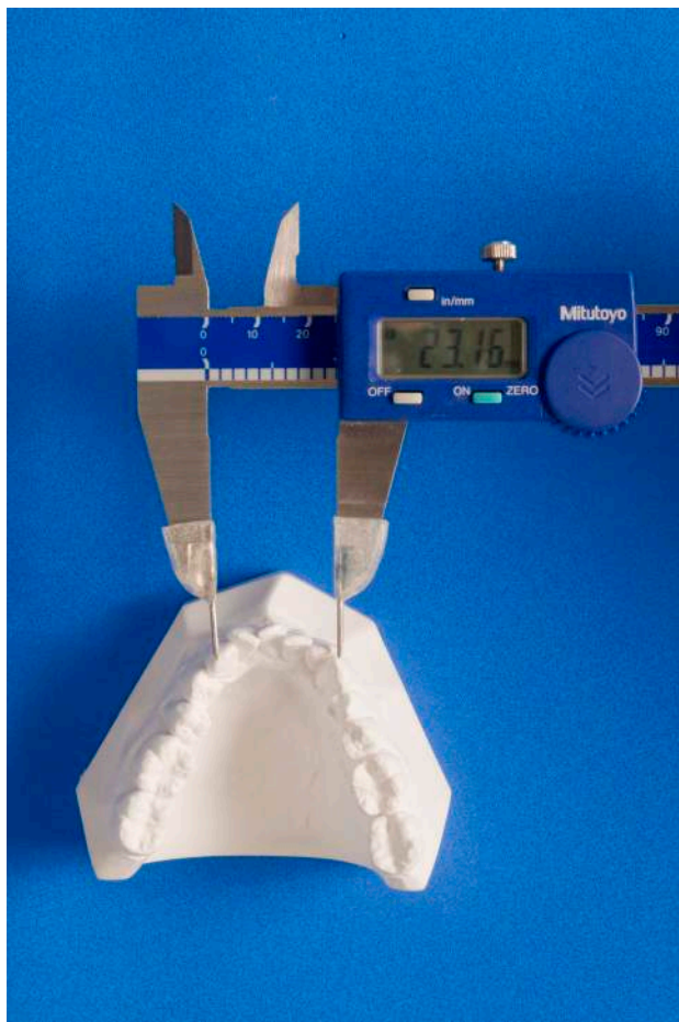
Figura 3 - Paquímetro Mitutoyo Digimatic Caliper – Modificado ((Mitutoyo Sul Americana LTDA, Indústria Brasileira, Suzano-SP).
