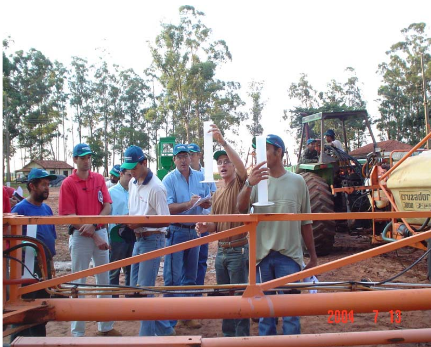
Figura 5. Aula prática - aferição de vazão das pontas com o uso de provetas plásticas pelos profissionais de campo. Campo Grande-MS. 2006
