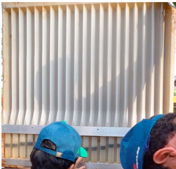
Figura 1. Mesa de deposição de calda para avaliação do coeficiente de variação da distribuição da barra pulverizadora na inspeção de pulverizadores. Campo Grande-MS. 2006.
