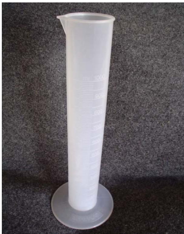
Figura 2. Proveta plástica J. Prolab - 1.000 mL para avaliação da vazão de pontas na inspeção de pulverizadores. Campo Grande-MS. 2006.
