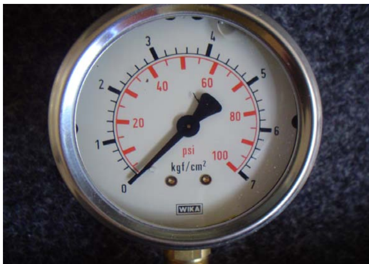
Figura 3. Painel do manômetro em glicerina - 100 psi para verificação da pressão nas pontas de pulverização na inspeção de pulverizadores. Campo Grande-MS. 2006.
