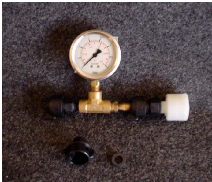
Figura 4. Manômetro em glicerina - 100 psi para verificação da pressão nas pontas de pulverização na inspeção de pulverizadores. Campo Grande-MS. 2006.
