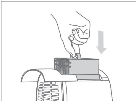
4. Legen Sie die Obere Abdeckung des Körpers so zurück, dass Sie in die Schlitzte passt, und schieben Sie den Griff zurück in seine ursprüngliche position.
