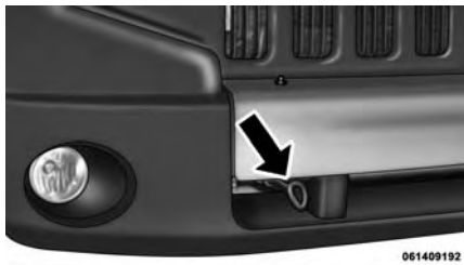
Anilla para remolque delantera instalada
