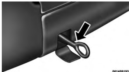
Anilla para remolque trasera instalada
