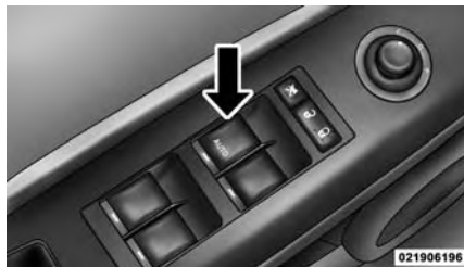
Ubicación del interruptor de las ventanas eléctricas
