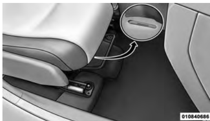
Ubicación del Número de identificación del vehículo en la carrocería delantera derecha
