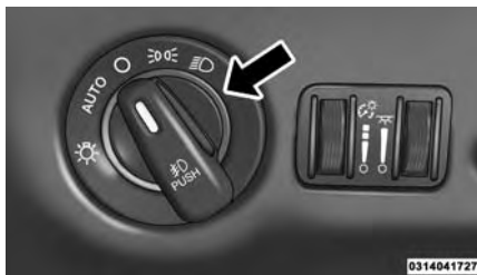
Interruptor de los faros con control de luces auxiliares
