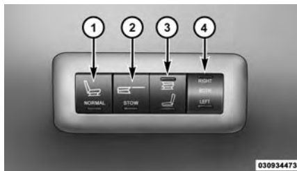
Banco de interruptores eléctricos del panel trasero
