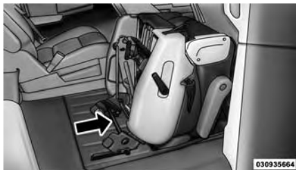
Viga transversal para la extracción del asiento
