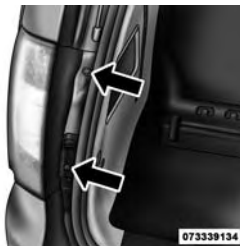
Tornillos de montaje de la luz trasera
