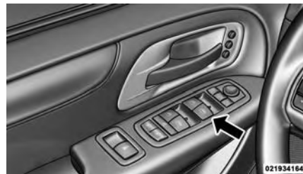
Interruptores de las ventanas eléctricas del conductor
