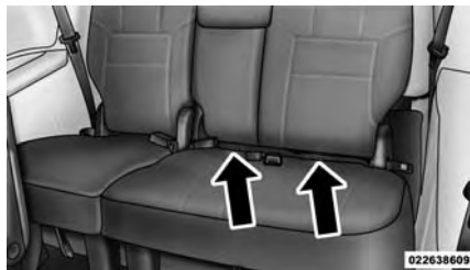
Anclajes LATCH (se muestran los anclajes 60/40 de la tercera fila)
