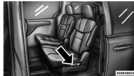
Palanca reclinatora del respaldo del asiento, abatimiento del asiento y palanca de plegado del apoyacabezas
