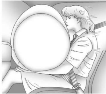
La bolsa de aire delantera del pasajero exterior está en el lateral del tablero de instrumentos.
