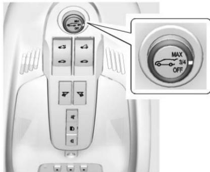
En vehículos con puerta levadiza eléctrica, el vehículo debe estar en P (estacionamiento) para usar la característica eléctrica. Las luces traseras parpadean cuando se mueve la puerta trasera eléctrica.
