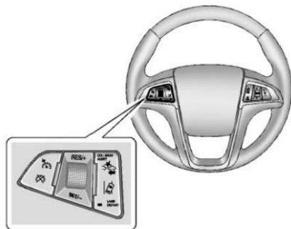
Para encender y apagar LDW, oprima el botón LANE DEPART (Salida de carril) en el volante. El indicador del control se enciende cuando LDW está activado.
