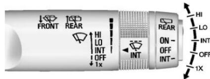
La palanca del limpiador/lavador del parabrisas está ubicada del lado derecho de la columna de dirección. Con el encendido en ACC/ACCESSORY (acc/accesorio) u ON/RUN/START (encendido/
