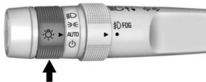
El control de las luces exteriores está en la palanca de las direccionales.
