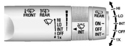
La palanca del limpiaparabrisas/lavador está en el lado derecho de la columna de dirección. Con la ignición en ACC/ACCESSORY (acc/accesorio) o ON/RUN/START
