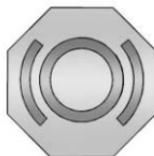
El depósito del cilindro maestro de frenos se llena con líquido de frenos DOT 3 aprobado por GM, como se indica en el tapón del depósito. Vea en *Vista general del compartimiento del motor* ⇨ 239 la ubicación del depósito.
