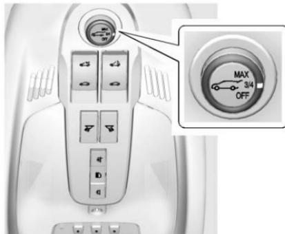
Si está equipado, el interruptor de la compuerta levadiza está en la consola superior. El vehículo debe estar en P (estacionamiento) para operar. Las luces traseras parpadean cuando la puerta trasera eléctrica está en movimiento.
