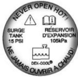
1. Retire el tapón de presión del tanque de compensación del refrigerante cuando el sistema de enfriamiento, incluyendo el tapón de presión del tanque de compensación del refrigerante y la manguera superior del radiador, ya no están calientes. Haga girar el tapón de presión lentamente un cuarto de vuelta en sentido inverso al de las manecillas del reloj. Si escucha un silbido, espere hasta que desaparezca. Esto permitirá que toda la presión que aún haya quedado salga por la manguera de descarga.
