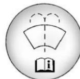
Abra el tapón que tiene el símbolo del lavaparabrisas. Agregue líquido para lavaparabrisas hasta llenar el tanque. Vea en *Vista general del compartimiento del motor* ⇨ 239 la ubicación del depósito.
