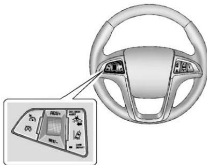
El control de alerta de colisión se encuentra en el volante. Oprima COLLISION ALERT (ALERTA DE COLISIÓN) para ajustar el tiempo de alarma de FCA a lejos, medio, cerca o apagado. La primera opresión del botón muestra la configuración actual del control en el DIC. Opresiones adicionales del
