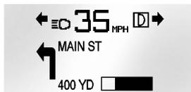
La imagen HUD que se muestra en el parabrisas automáticamente bajará y subirá su brillo para compensar la iluminación exterior. Sin embargo, el control de brillo del HUD puede ser ajustado según se requiera.
