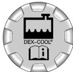
3. Haga girar el tapón de la varilla de medición del refrigerante en sentido inverso al de las manecillas del reloj y saque lentamente la varilla de medición.
