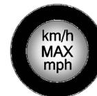
16. Si fue posible inflar la llanta desinflada a la presión de inflado recomendada, retire la etiqueta de velocidad máxima del recipiente de sellador y colóquela en un sitio muy visible. No exceda la velocidad en esta etiqueta hasta que la llanta dañada sea reparada o sustituida.
