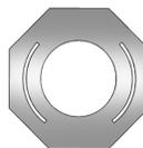
El tapón del depósito del líquido de frenos/embrague hidráulico tiene este símbolo. El depósito común de líquido del embrague hidráulico y líquido del cilindro maestro de frenos se llena con líquido para frenos DOT 3, como se indica en el tapón del depósito. Vea en *Info gral s/compartim motor en la página 10-6* la ubicación del depósito.
