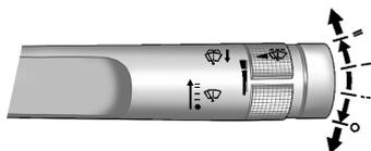
Empuje hacia arriba la palanca o jálela hacia abajo para colocarla en una de las posiciones siguientes.
