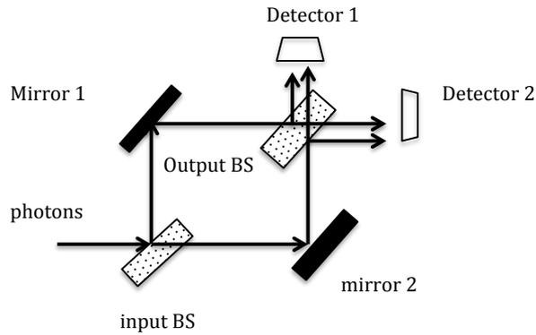
Fig. 3 Regular Mach-Zehnder Interferometer
