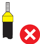
Cabo com terminal isolado
