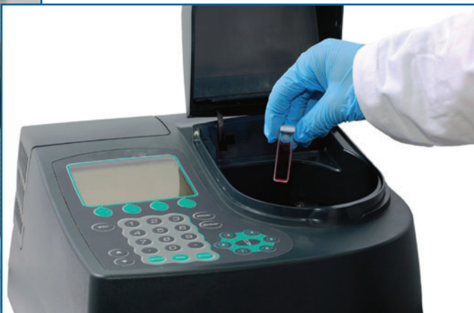
Un spectrophotomètre : mesurer l'absorbance à une longueur d'onde donnée.
