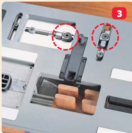
Frästisch nach links verschieben und fixieren. Fräsen des linken vorderen Zapfens.
