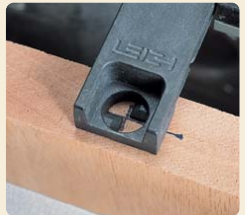
6. ... bis Fadenkreuzanschlag exakt mit Werkstückmittelpunkt fluchtet.
