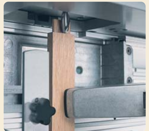
9. Zapfen fräsen. Alle anderen Zapfenteile werden ohne weiteres Anzeichnen des Mittelpunktes gefräst, da der Seitenanschlag die Werkstücke stets gleich fixiert.
