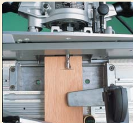
8. Oberfräse (mit montierter Grundplatte) auf Frästisch stellen und Maschine auf benötigte Frästiefe absenken.
