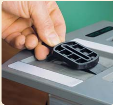
2. Passenden Fräser und Fräsführung auswählen. Fräser in Oberfräse einspannen und Fräsführung in Frästisch einklicken.
