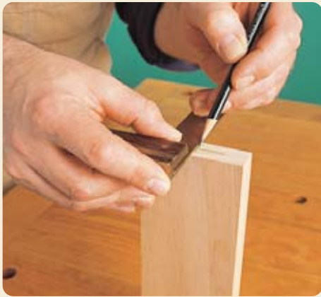
1. Mittelpunkt des Werkstückes anzeichnen (nur an einem Ende – nur eines Werkstückes).
