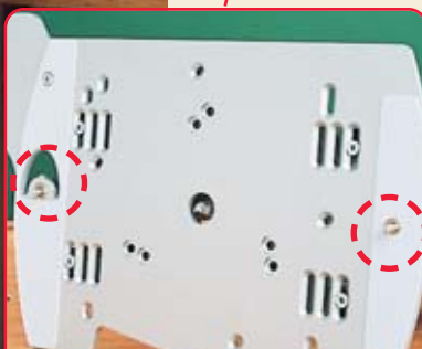
Zwei konisch verstellbare Präzisionsstifte führen die Grundplatte
