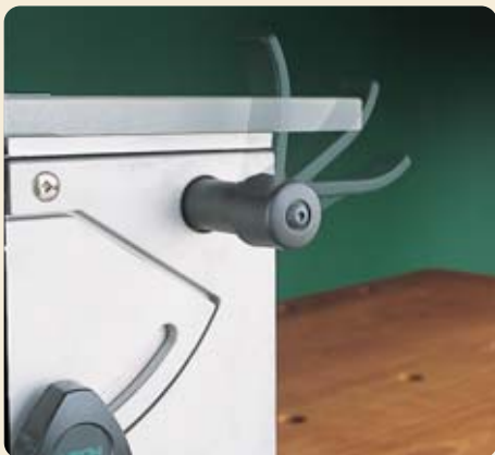
7. Frästisch festspannen und Fadenkreuzanschlag zurückschieben.
