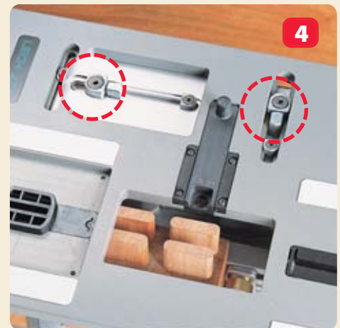
Frästisch nach vorne verschieben und fixieren. Fräsen des rechten vorderen Zapfens.
