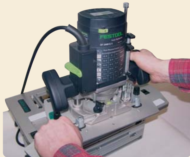
Die Oberfräse wird mit der Grundplatte präzise auf dem FMT geführt.
