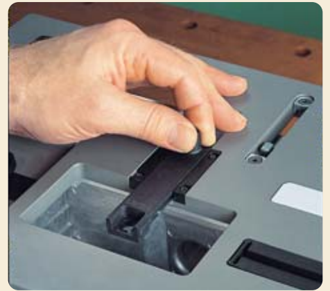
3. Fadenkreuzanschlag nach vorne schieben.
