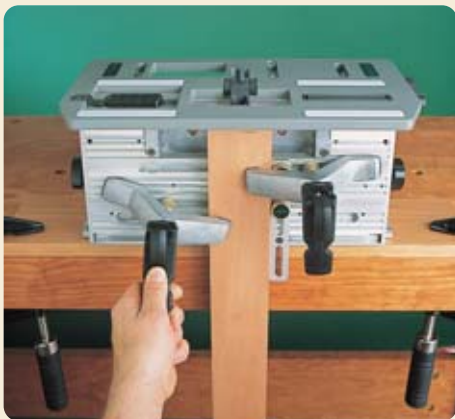
4. Schlitzteil gegen den Seitenanschlag spannen.
