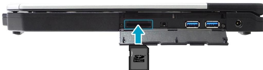
3. 将存储卡推入存储卡槽，直至其卡入到位。
