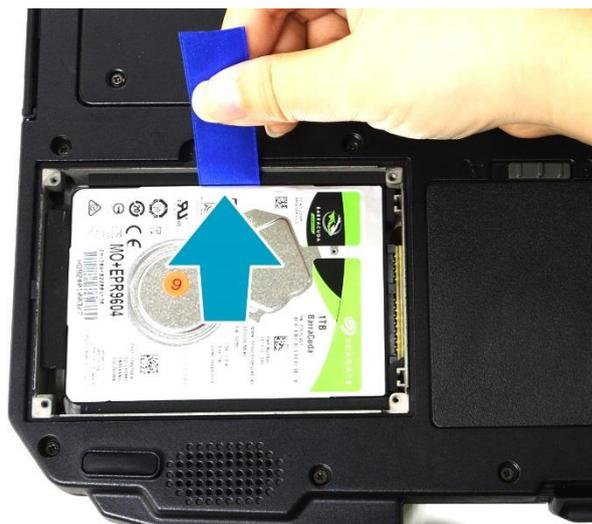
4. 断开 HDD 模块与主板连接器的连接。
