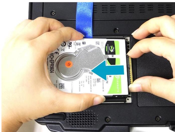
5. 将 HDD 模块连接到主板连接器（可在 HDD 硬盘盒内部看到）。
