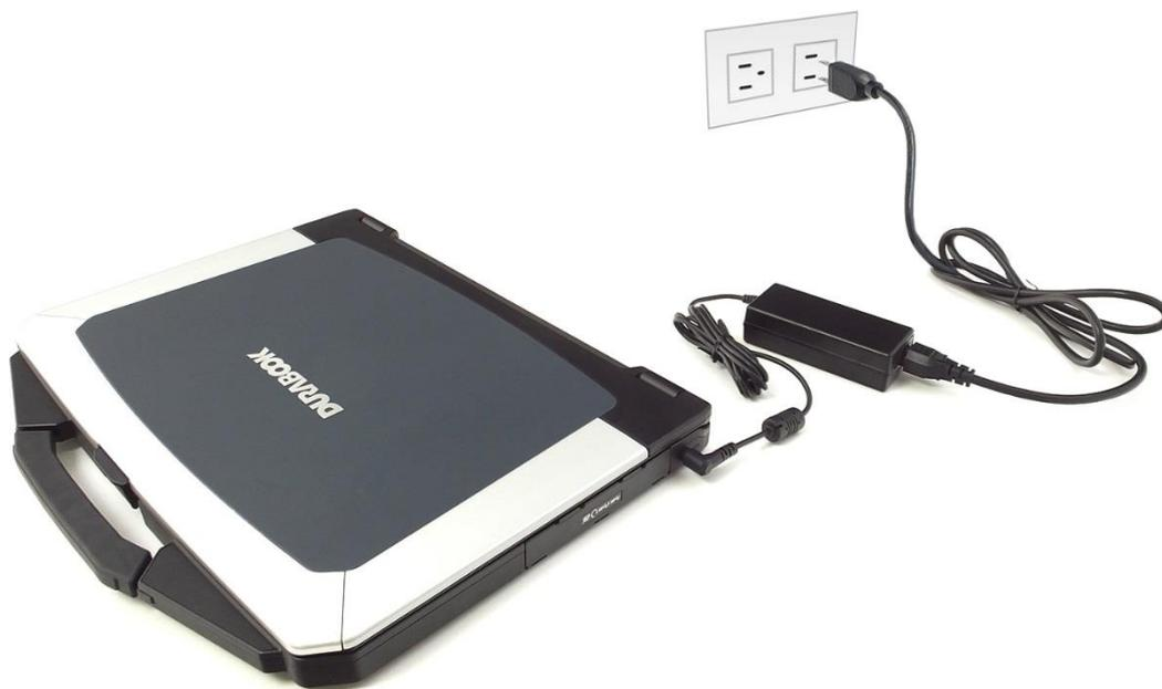
1. 将交流电源适配器连接至笔记本电脑的直流输入插孔。
