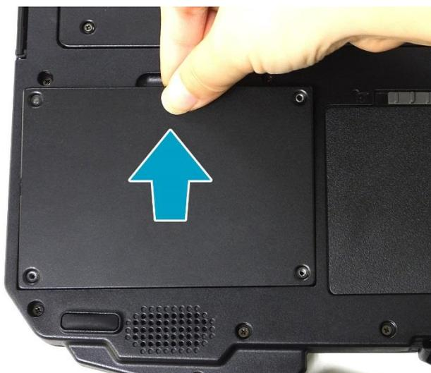
3. 使用拉片释放 HDD 硬盘盒中的 HDD 模块。现在不要取出 HDD 模块！
