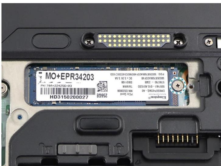
4. 断开 SSD #1 模块与主板连接器的连接。
