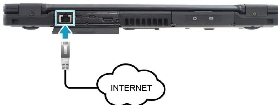
3. 将以太网线的另一端连接到路由器。
