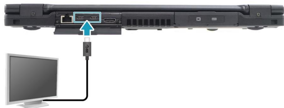
3. 将线缆的另一端连接到外置显示器。
