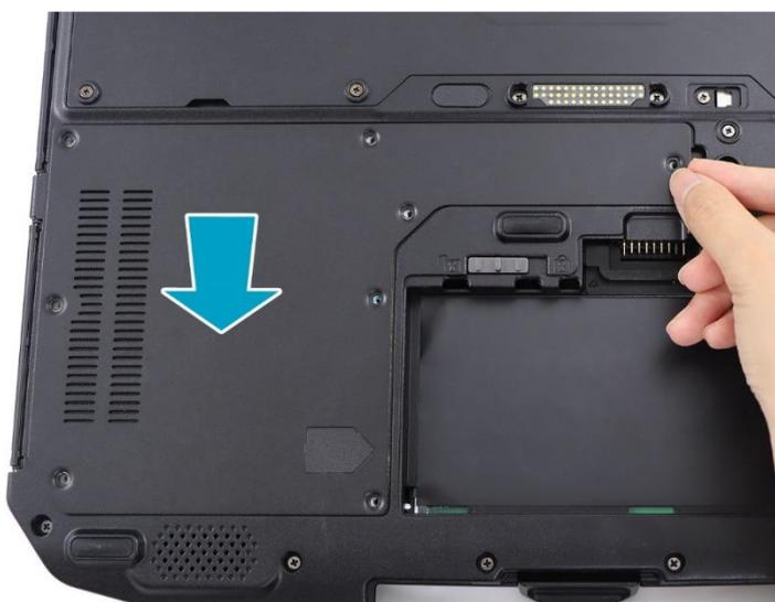
8. 拧上八枚 (8) 螺钉，将存储器和内存盒盖固定到设备上。
