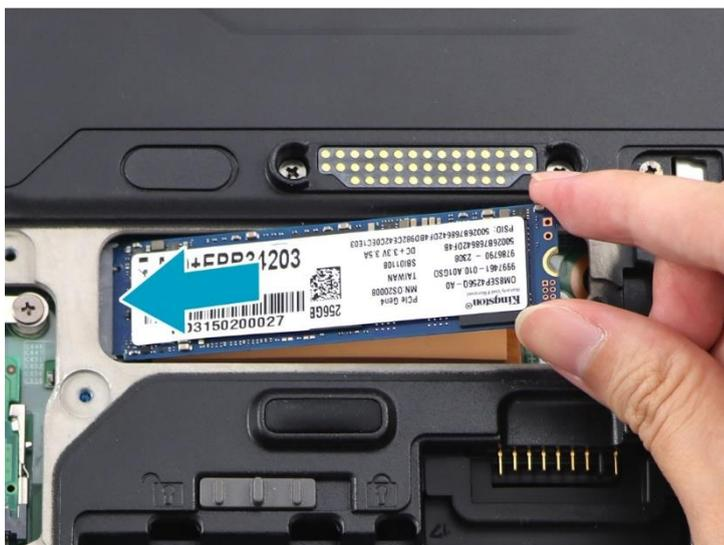
6. 拧上螺钉，将 SSD #1 模块固定到主板。
