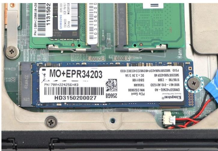
4. 断开 SSD #2 模块与主板连接器的连接。
