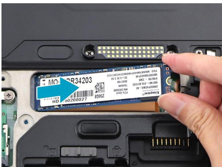
5. 将新 SSD #1 模块连接到主板连接器。
