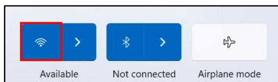
2. 在无线选项卡中单击 (
