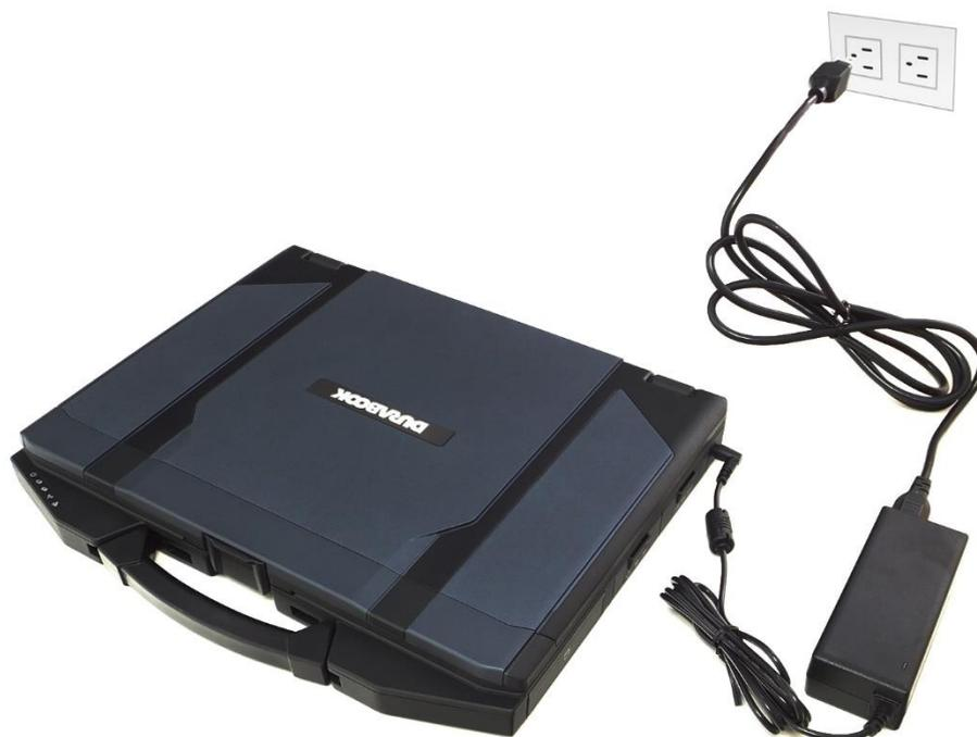
1. 将交流电源适配器连接至笔记本电脑的直流输入插孔。
