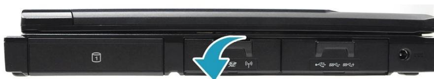
2. 将存储卡推入存储卡槽，直至其卡入到位。
