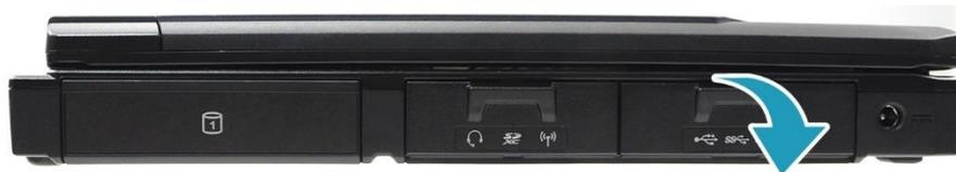
2. 将 USB 线的一端连接到设备的 USB 端口。
