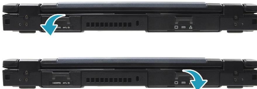
2. 将 HDMI 或 VGA 线的一端连接到设备的 HDMI Port 或 VGA 端口。
