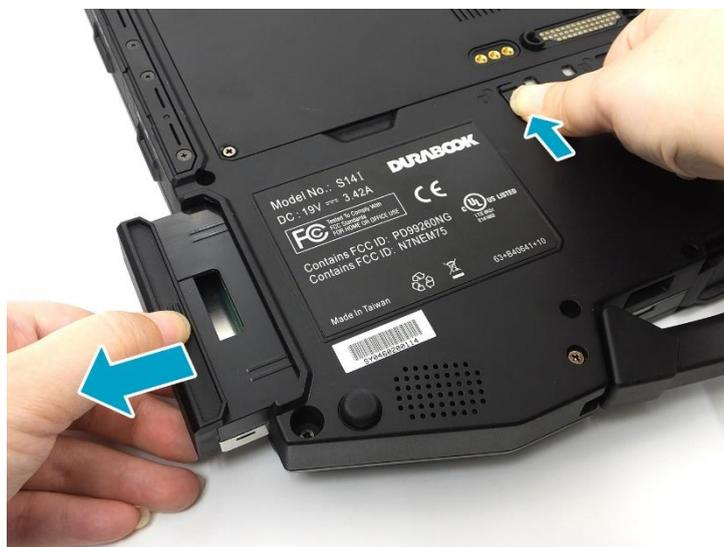
3. 将新的 HDD 插入 HDD 盒。然后将 HDD 完全推入，直至其锁定到位。
