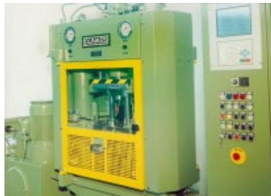
1. 2-Säulen-Pulverpresse für Diamantpulver, 250 kN
