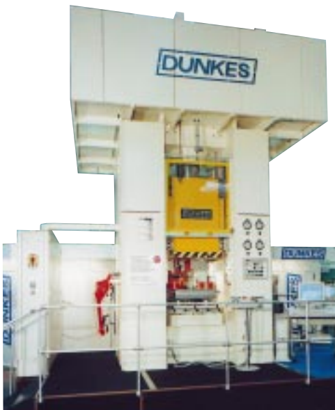
2. Doppelständer- presse mit Ausstoßer und Auswerferachse, 3150 kN
