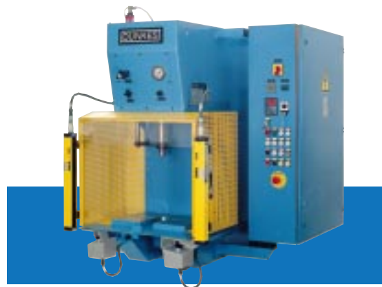
8. Einzelständer-Tischpresse mit Lichtschränke, 63 kN
