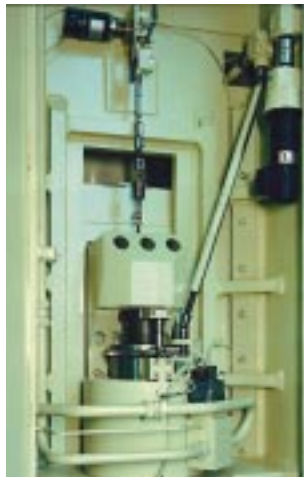
2a) Schnittschlagdämpfung im Seitenständer mit mechanischem Tiefenanschlag
