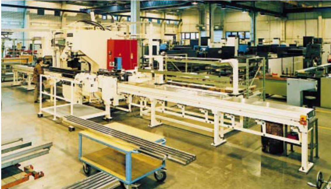
1. Hydraulische Richtanlage für Profilmaterial mit Torsionseinrichtung, Meßstation und Waagrecht-Richteinheit, 630 kN / 1000 kN, Torsionsmoment 250000 N/m
