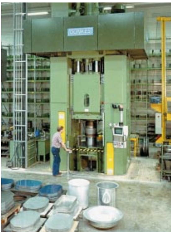
8. 3fach wirkende Doppelständer-Tiefziehpresse 5000 kN mit Werkzeugwechselregal
