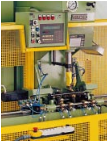
7. Detail halbautomatische Richtpresse mit NC-Steuerung, motorischem Dreh- und Fahrtrieb, 250 kN
