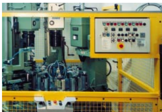
3. Rundschanttelernietanlage mit 6 Stationen, mechanisch schaltendem Rundschantelteller, Prüfstation für Niethöhe, Kraft-Weg-Kontrolle und Werkstückspannung (20/40 kN Nietkraft)
