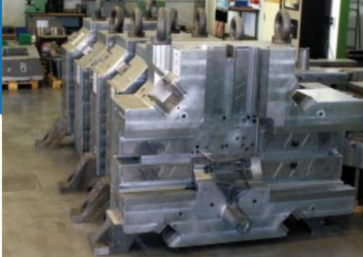
Druckgüßformen für Mercedes-Benz Getriebegehäuse. Formgewicht 22 Tonnen.
