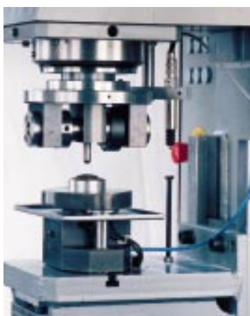
1b) Anordnung Rolliereinheit, Kraftmeßdose, Wegaufnehmer
