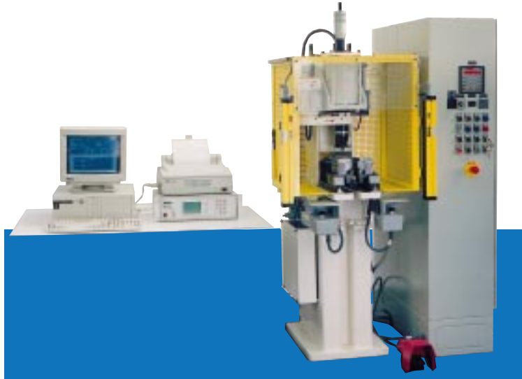
4. Taumelnietmaschine mit Schiebetisch, Werkstückspannung, Kraft-Weg-Kontrolle, NC-Steuerung, PC und Drucker (20 kN)
