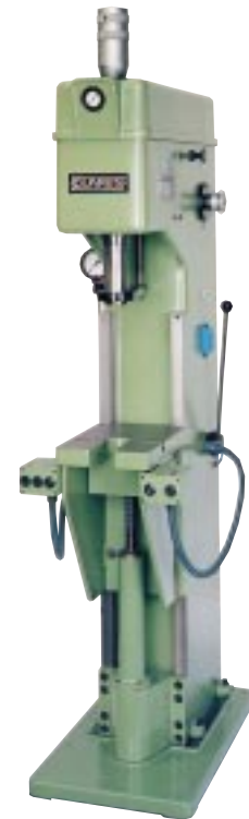
2. Pneumatische Einständerpresse mit verstellbarem Tisch, feinfühligster Handhebelsteuerung und umschaltbar auf Zweihand-Auslösung
