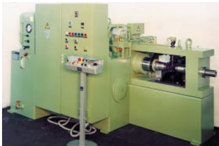
13. Waagrecht-Montagepresse mit Automation, 630 kN
