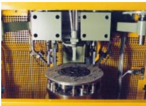
9. Detail drückendes Nietverfahren mit automatischer Nietzuführung
