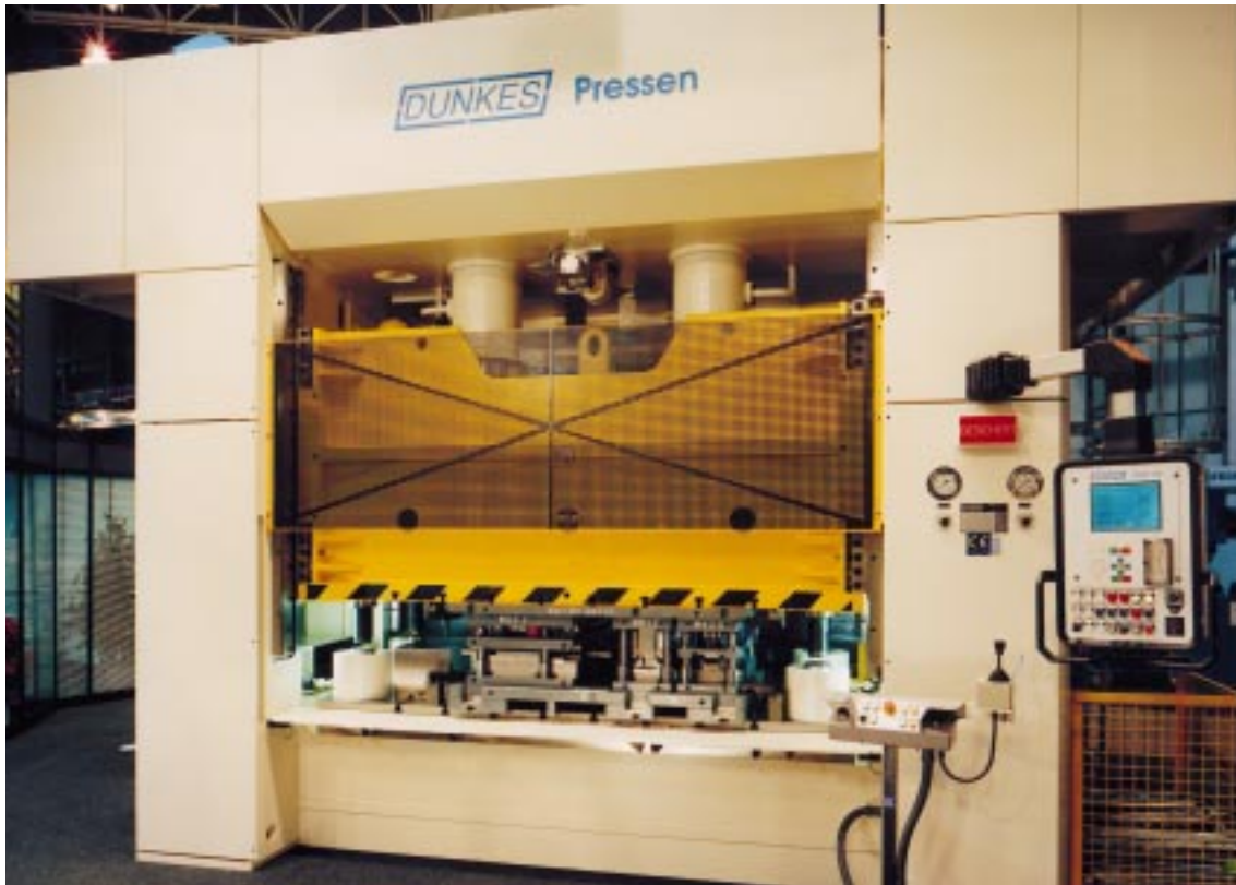
2. Doppelständer- Try-Out-Pressen für Folgeberbundwerk- zeuge, 2zylindrig mit Servolageregelung, 2-Hand- und Handhebel- steuerung (Joy-Stick) einschl. Schnittschlag- dämpfung und Parallelhaltung (2500 kN)
