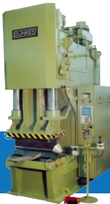
9. 2zylindrige Einständerpresse mit feinfühler Handhebelsteuerung und servogeregelter Stößelachse, 2000 kN
