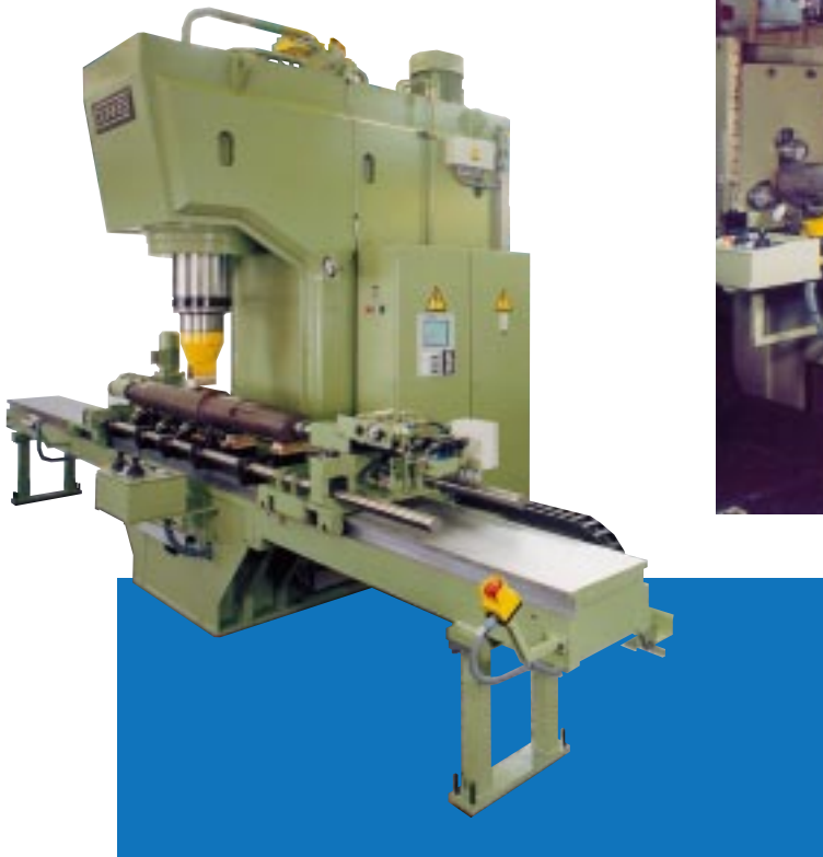
5. Richtpresse mit servogeregelter Stößelachse, motorischem Dreh- und Fahrtrieb, 3150 kN
