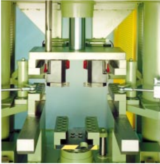
1c) Einbauraum ohne Werkzeug mit hydraulischen Werkzeugspannleisten
