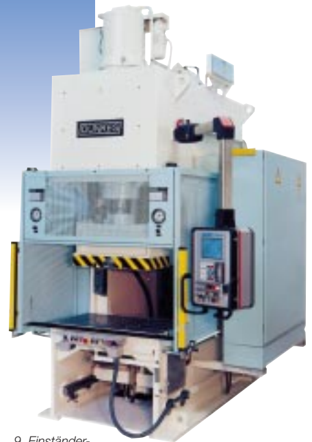
9. Einständer-Stanzpresse mit 6fach geführtem Stößel 1600 kN
