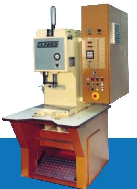
3. Einständer-Tischpresse mit NC-Steuerung, konzipiert als Sitz-arbeitsplatz nach ergonomischen Gesichtspunkten, Preßkraft 40 kN
