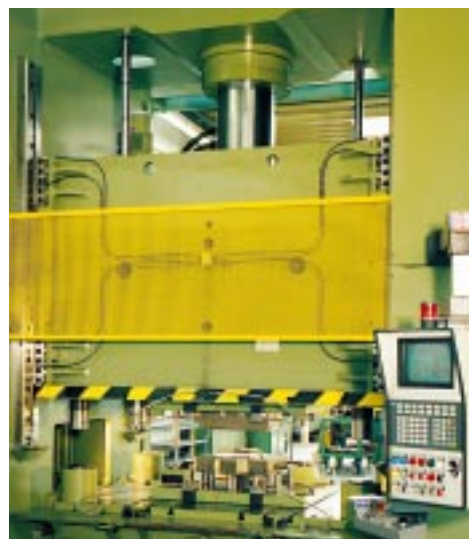
5. Doppelständerpresse mit 4fach-Schnittschlagdämpfung 4000 kN
