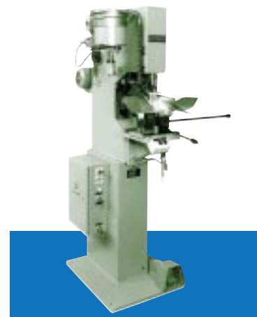
10. Drückendes Nietverfahren mit automatischer Nietzuführung (10 kN)
