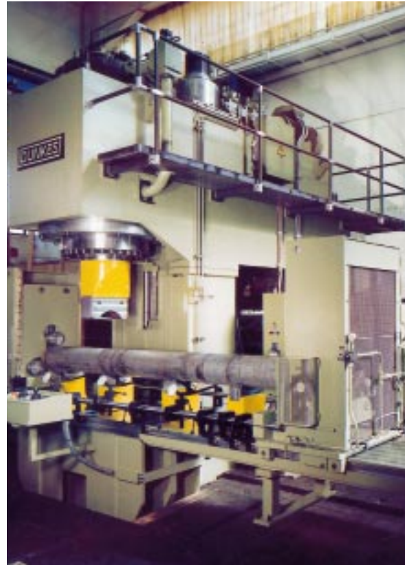
4. Richtpresse mit servogeregelter Stößelachse, Joy-Stick-Steuerung mit Dreh- und Fahrtrieb, 10000 kN
