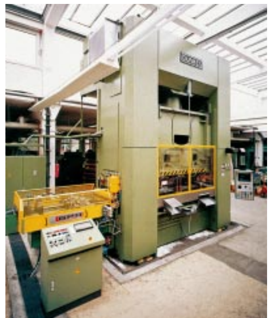
2. Doppelständer-Stanz- und Ziehpresse mit Transfereinrichtung, 4000 kN
