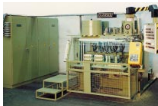
8. Automatische Nietanlage mit 12facher Krampenzuführung für Armaturenbrett
