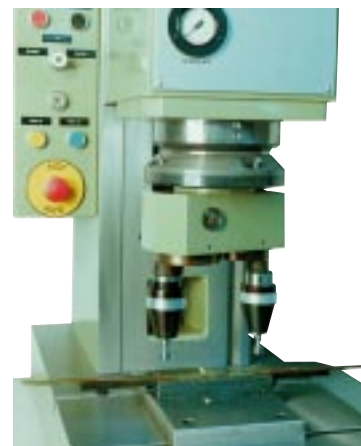
8. DUNKES Präzisions-Taumelnietmaschine mit Mehrspindel-nietkopf (20 kN)
