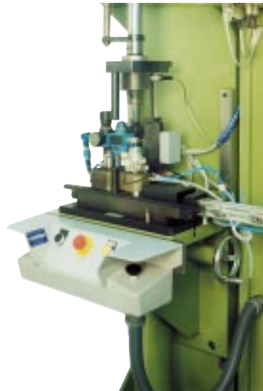
9. Einzelständerpresse mit verstellbarem Tisch, 40 kN
