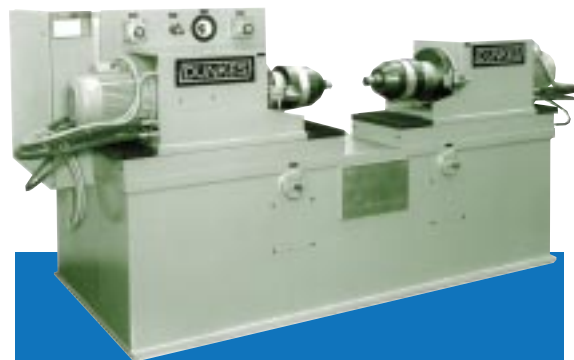
5. Waagrechte Nietanlage mit hydraulischen Nietaggregaten (je 100 kN)
