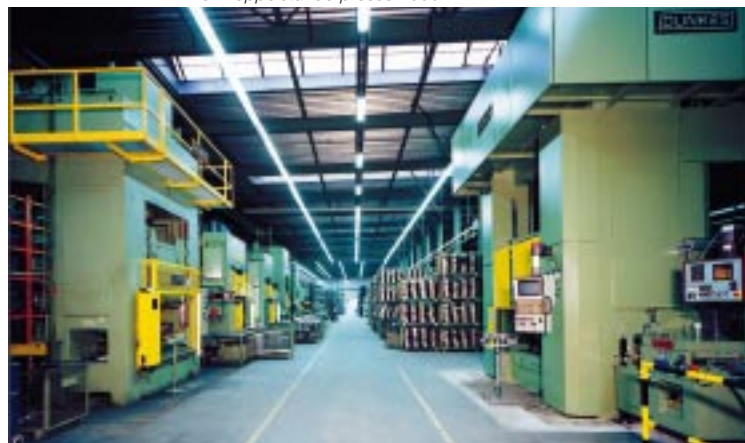
4. Pressenlinie 1000 - 4000 kN mit Werkzeugwechselregal/ Bandanlage
