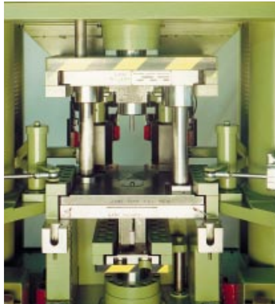
1a) Einbausituation Werkzeug mit aut. Spannung
