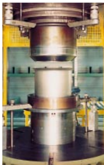
8a) Detail Ziehwerkzeug
