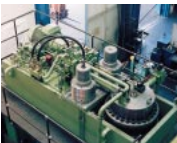
4b) Hydraulischer Antrieb/ Zugankerbauweise
