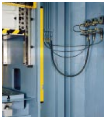
4. Blechverkleidung in geöffneter Stellung bei Doppelständerpresse
