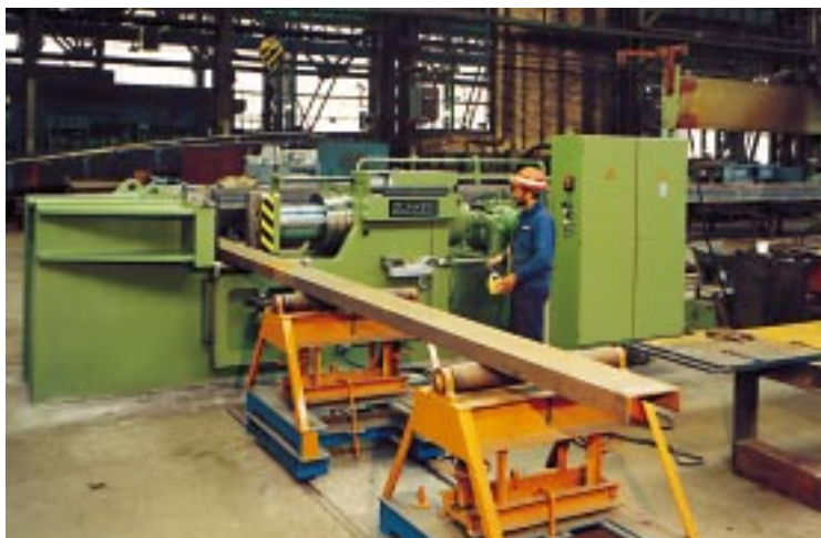
3. Waagrecht-Richtpresse mit feinfühligster Handhebelsteuerung einschließlich Rollenböcke für Profile, 3150 kN
