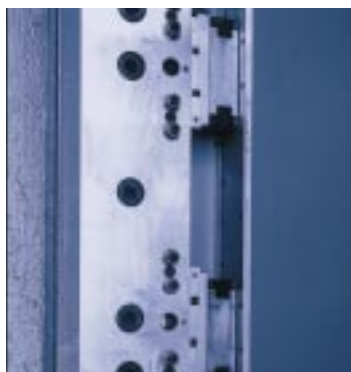
5. 6fach Flachführung an Einständerpresse 8. vorgespannte Rollenumlaufschuhe
