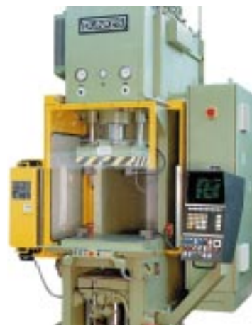
10. Einständer- presse mit verfahr- barem Ziehkissen 1600 kN
