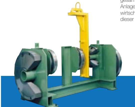
2. Werkzeuggestell für Wechselaufnahmen
