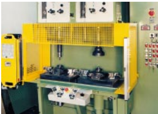
4. Montagepresse mit 2 Zylinder für parallel laufende Arbeitsgänge (je 100 kN)
