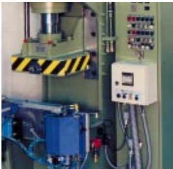
4. Einständer- Stanzpresse mit Handlingeinrichtung und Stapelmagazin, 250 kN
