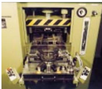
12. Doppelständerpresse mit Schiebetisch, säulengeführter Stoßelplatte, 250 kN
