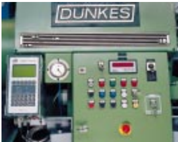
1a) Bedienpult mit Kraft-Weg-Kontrolle, digitaler Preßkraftanzeige
