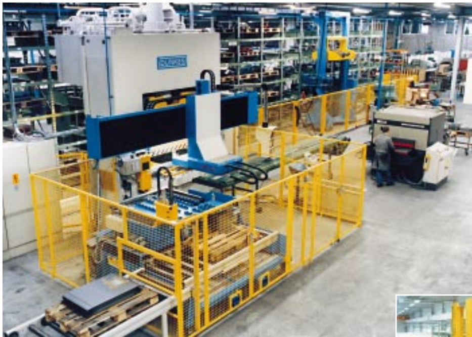
1. Stanzzentrum mit automati- schem Werkzeugwechsel und Platinenbeschickung 3150 kN
