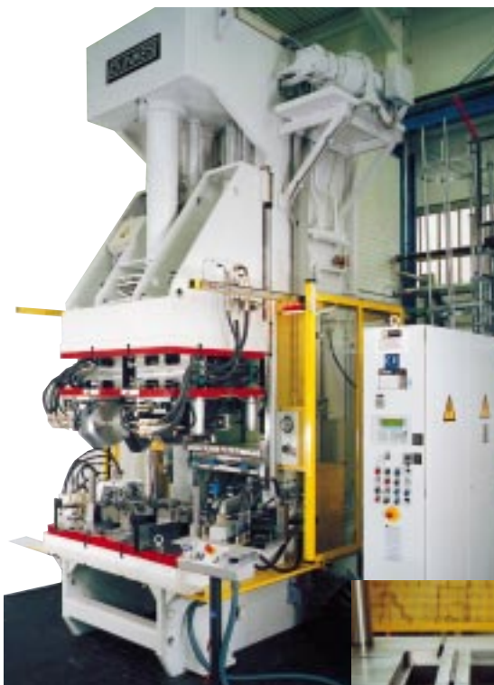
1. Einständer-Entgratpresse mit NC-Steuerung, hydraulischen Seitenschiebern, Lichtschranke, Gießteilentnahme, Niederhalterfunktion usw., 320 kN.
