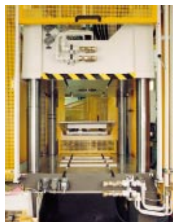
2c) hydraulische/elektrische Anschlüsse für Seitenschieber
