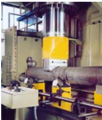
4a) Detail motorisch angetriebene Rollenaufgabe
