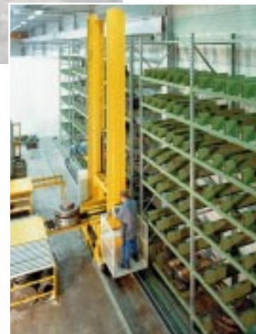
3. Werkzeug- wechselregal, Werkzeuggewicht max. 2500 kg
