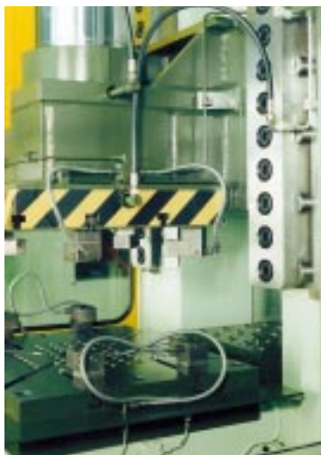
1b) Prismaengeführter Stößel mit hydraulischer Werkzeugspannung
