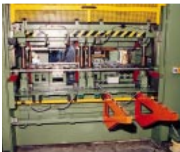
3a) Detail- Transferwerkzeug mit verschiebbaren Werkzeugwechsel- tragarmen
