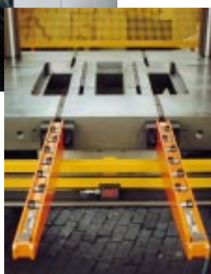
2b) Tragarme für Werkzeugwechsel
