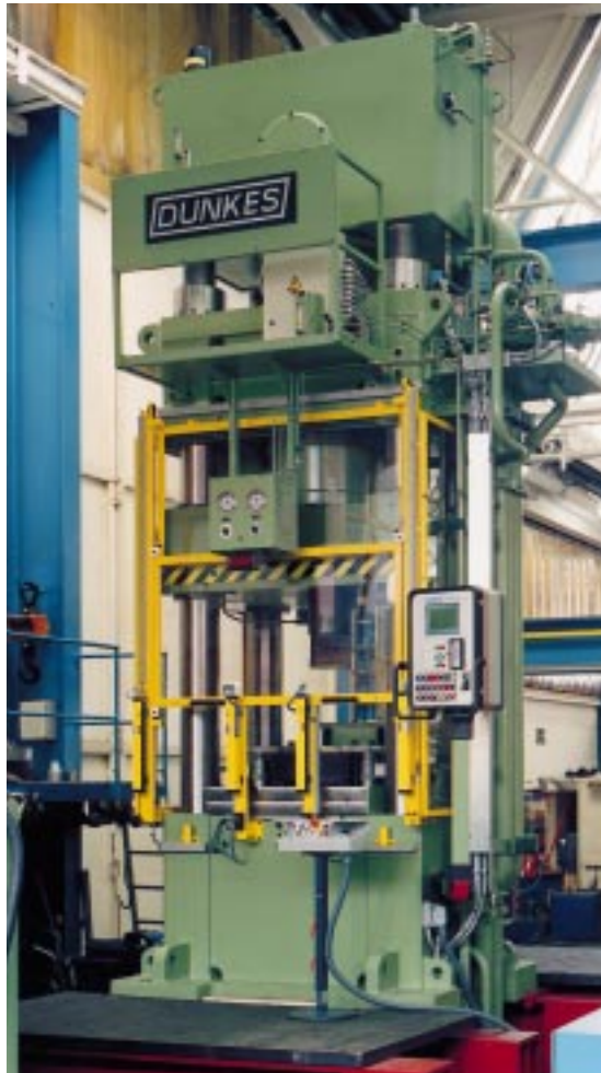
1. 4-Säulen- presse mit CNC- Steuerung, auto- matischer Beschickung, 5000 kN
