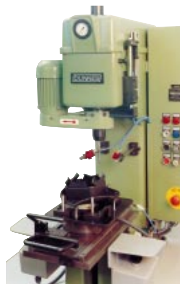
2. Taumelnietmaschine mit Schiebetisch, Kraft-Weg-Kontrolle (20 kN)
