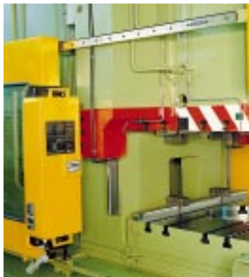
7. Einständerpresse Detail - prismageführter Stößel - Lichtschränke nach hinten verfahrbar 2500 kN
