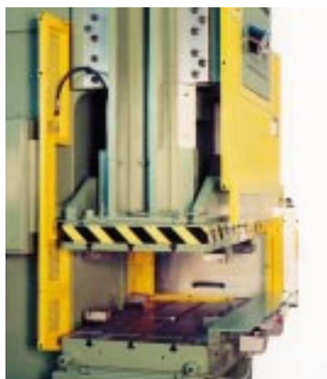
7. prismageführter Stößel am Kopfstück
