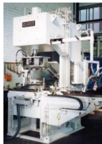
3. Einständer-Entgratpresse mit Schiebepipptisch, Ausblasstation, Gießteilentnahme, 250 kN
