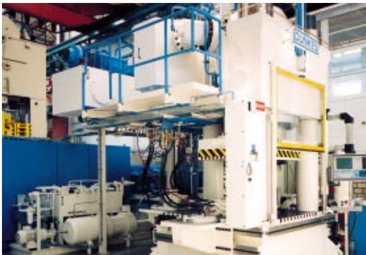
1a) Detailansicht Zusatzachsen, Hochdruckaggregat
