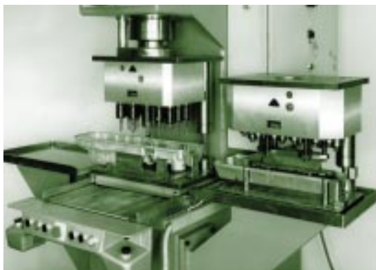
4. Einständer-Taumelnietmaschine mit Mehrspindel-nietkopf und Werkzeugwechsel (100 kN)
