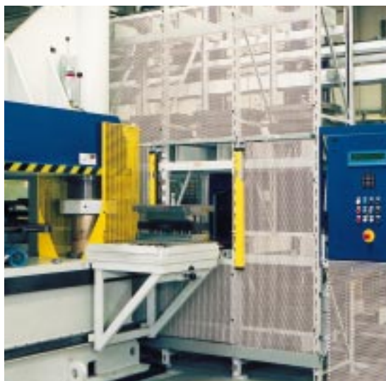
1b) Werkzeugübergabe aus Lagerregal auf Wechselhilfe
