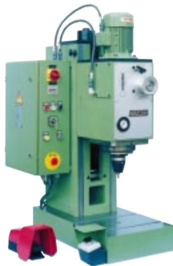
7. DUNKES-Präzisions-Taumelnietmaschine mit verstellbarem Kopfstück (20 kN)
