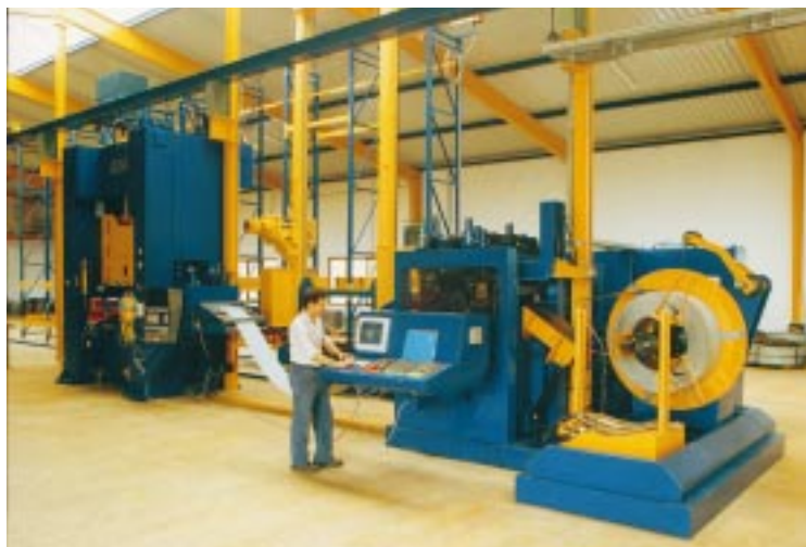
7. Doppelständer- presse mit Band- anlage, Haspel, Richtmaschine und Werkzeugwechsel- regal, 4000 kN
