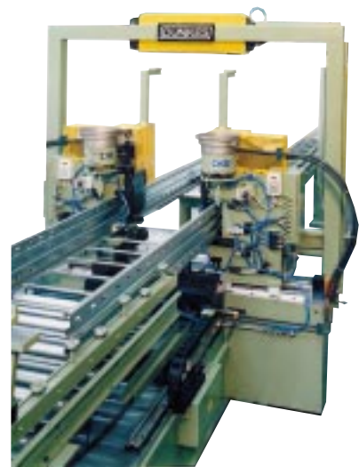
6. Nietanlage mit automatischer Nietzuführung über Sortierkessel, automatischer Werkstücktransporteinrichtung (je 40 kN Preßkraft)
