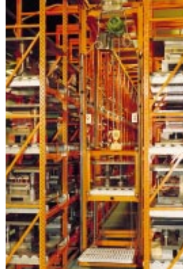
2. Werkzeug- wechselregal, doppelseitig, Werkzeuggewicht max. 1000 kg
