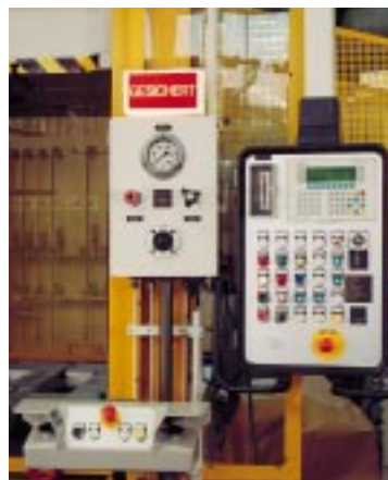
2a) Detail NC-Steuerung und Preßkraftanzeige über Manometer
