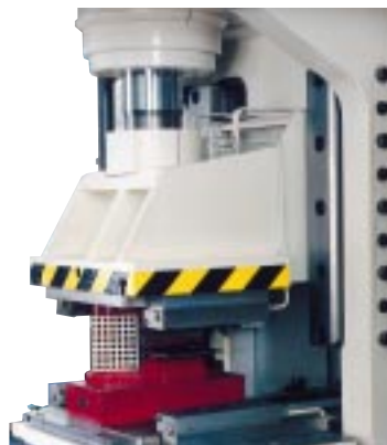
5. 6fach Flachführung an Einständerpresse 8. vorgespannte Rollenumlaufschuhe
