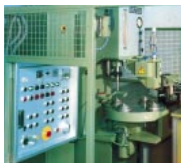
5. Einständerpresse mit Rundscheitler und automatischer Be- und Entladung, 250 kN
