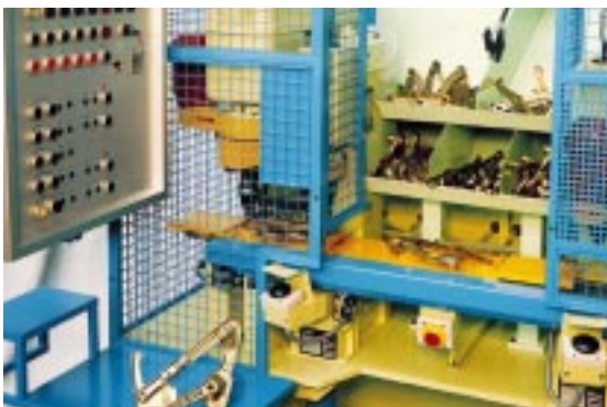
7. Taumelnietanlage als Sitzarbeitsplatz (Nietkraft je 20 kN)
