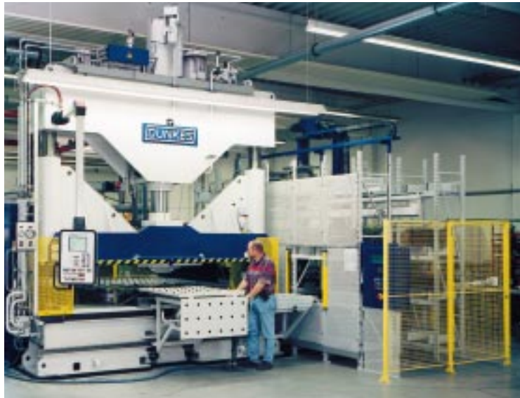
1. 2-Säulen-Stanzpresse mit automatischem Werkzeugwechselregal sowie Werkstückhandling, 1600 kN
