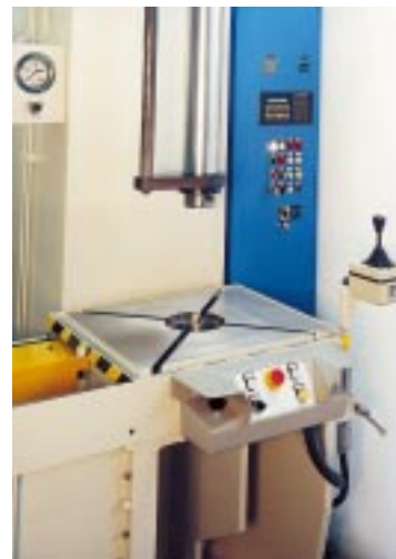
5. Einständerpresse umschaltbar auf Handhebelsteuerung und Schiebetisch, 160 kN
