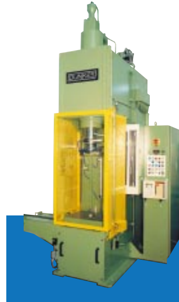
10. Einzelständerpresse mit Lichtschränke, Schiebetisch und Kraft-Weg-Kontrolle, 400 kN
