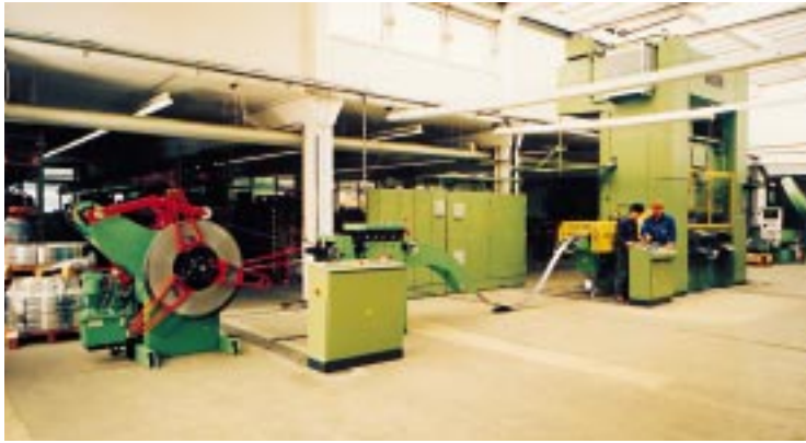
3. Doppelständerpresse mit Transfer- einrichtung, Haspel und Richtmaschine, 4000 kN
