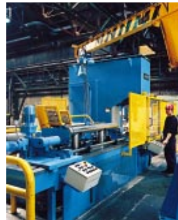
2. Richtpresse mit feinfühligster Handhebelsteuerung, motorisch verfahrenbarem Richtwagen, motorischem Drehantrieb und automatischer Beladestation, 1600 kN
