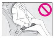
Le coussin gonflable SRS passager avant se déploie également avec une puissance considérable et peut occasionner des blessures graves, voire mortelles, notamment lorsque le passager avant se trouve très près du coussin gonflable. Le siège du passager avant doit se trouver le plus loin possible du coussin gonflable et le dossier doit être réglé de manière à ce que le passager avant soit assis bien droit.
