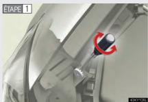
Tournez la vis A dans l'un ou l'autre sens au moyen d'un tournevis cruciforme (empreinte Phillips).
