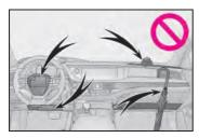
Ne fixez rien aux portes, à la vitre du pare-brise, aux vitres latérales, aux montants avant et arrière, au rail latéral de toit et à la poignée de maintien.
