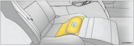
6 Coussin gonflable d'assise arrière SRS (avec siège de relaxation) Contribue à retenir le passager assis dans le siège de relaxation
