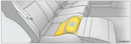
6 Airbag SRS d'assise de siège (siège de relaxation) Contribue à maintenir le passager assis dans le siège de relaxation
