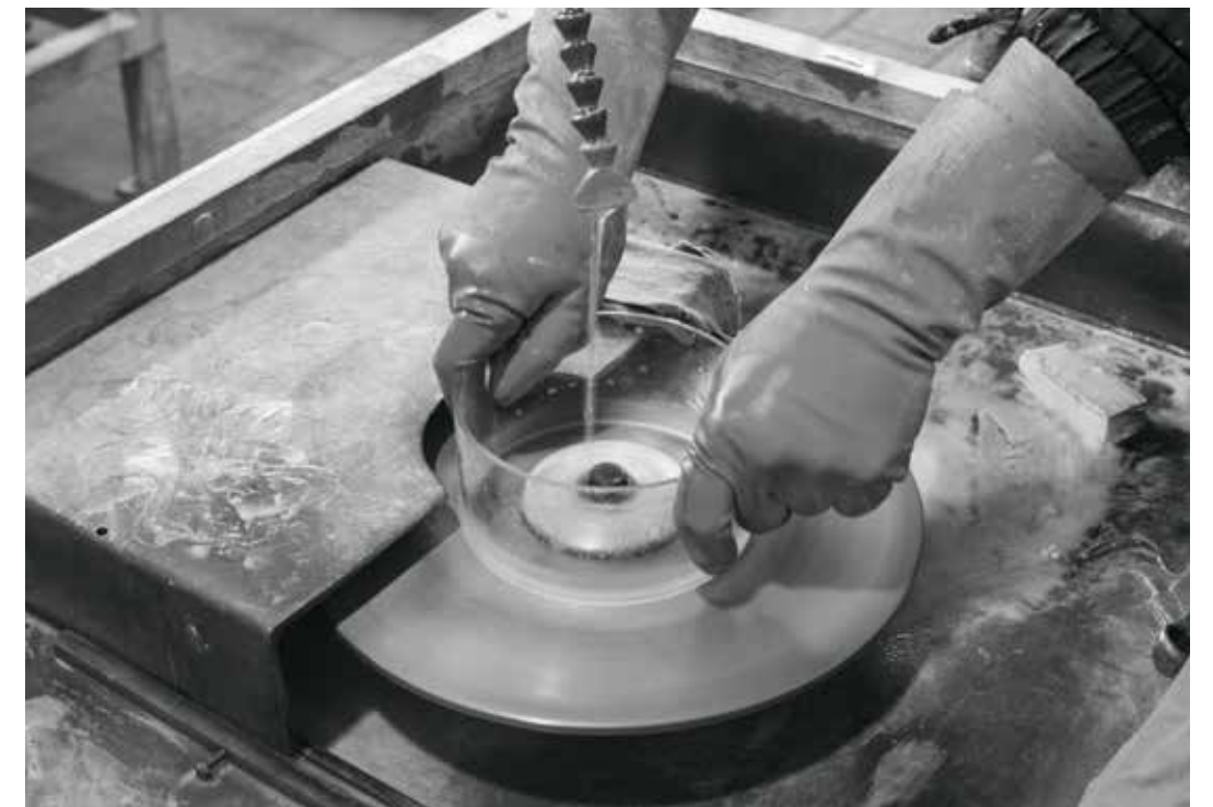
Ribrucciatura bordo anello Componi200 / Componi200 ring rim glazing / Rand-Neubrennen des Rings der Componi200 / Rebrûlage du bord de l'anneau Componi200 / Pulido al fuego borde anillo Componi200 Molatura anello Componi200 / Componi200 ring grinding / Schliff des Rings der Componi200 / Moulure de l'anneau Componi200 / Amoladura anillo Componi200
