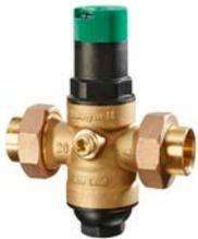
La vanne de régulation de pression DS06 DialSet de Honeywell est une vanne de régulation de pression de haute qualité qui maintient une pression de sortie constante pour une vaste gamme d'entrées de pression d'alimentation. Elle convient aux applications concernant l'eau potable et les irrigations. Le cadran de réglage de pression en aval élimine la nécessité d'avoir un indicateur de pression lors du réglage des paramètres de pression (pression statique seulement).
