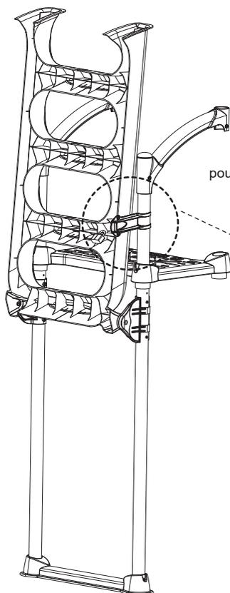
Utilisez le verrou coulissant comme guide pour percer le trou dans l'échelle en position haute. Utilisez un foret de 3/8".
