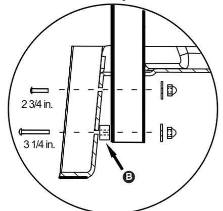
1) Commencez l'assemblage par les deux poteaux supérieurs. À l'aide d'une règle, choisissez les boulons nécessaires : deux de 2 3/4 po et deux de 3 1/4 po. Utilisez les deux cales d'espacement les plus hautes, ainsi que les rondelles et les écrous, comme indiqué sur le schéma. Assemblez les deux poteaux supérieurs, **SANS SERREZ POUR L'INSTANT.**
