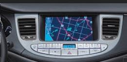
Système de navigation avec écran tactile de 6 1/2" et caméra de recul
