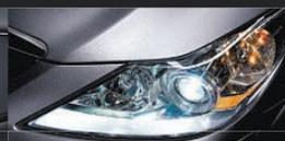
Phares à décharge à haute intensité au xénon autonivellants
