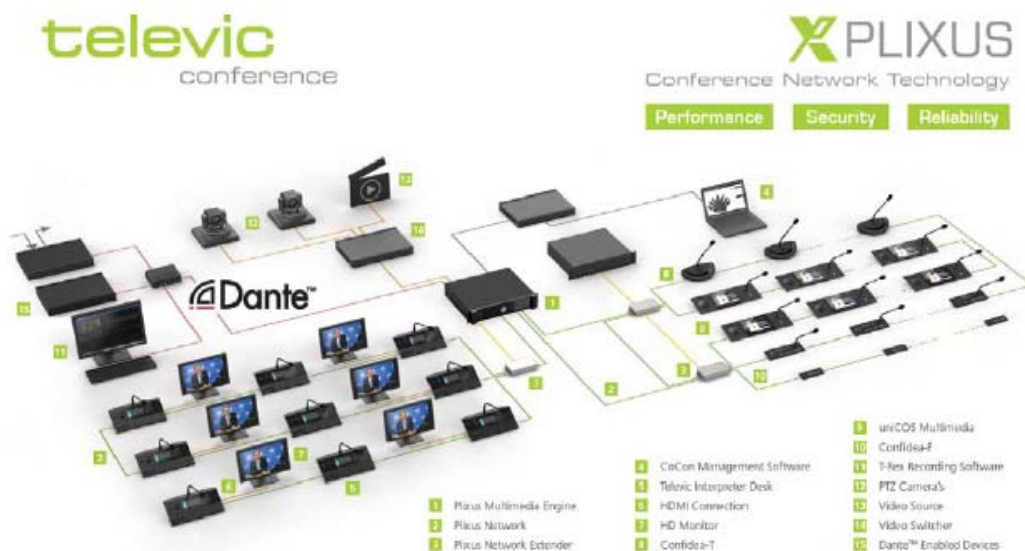
Рисунок 2: Схема архитектуры сети Plixus (пример конфигурации)
