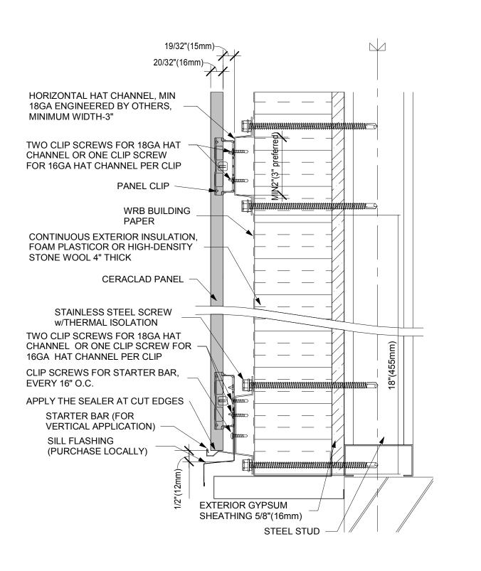
STARTER BAR (STEEL STUD) CERACLAD SIDING PANEL (16mm)
