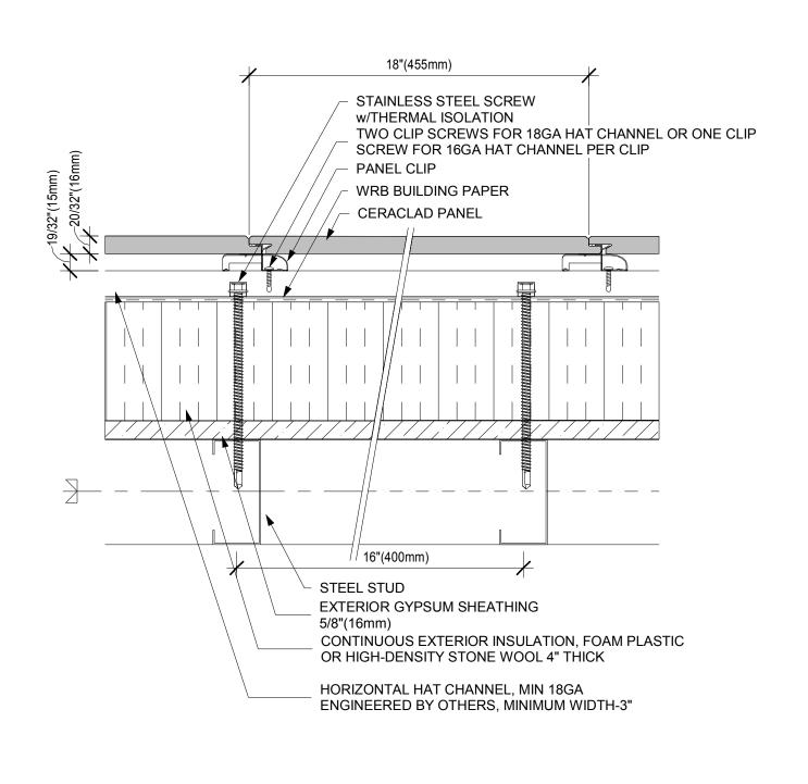
PANEL VERTICAL JOINT (HORIZONTAL SECTION)
