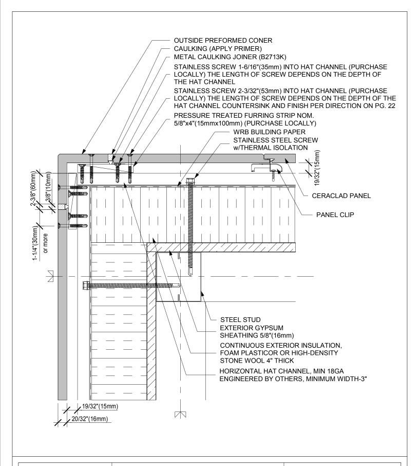
OUT SIDE PREFORMED CORNER (STEEL STUD)
