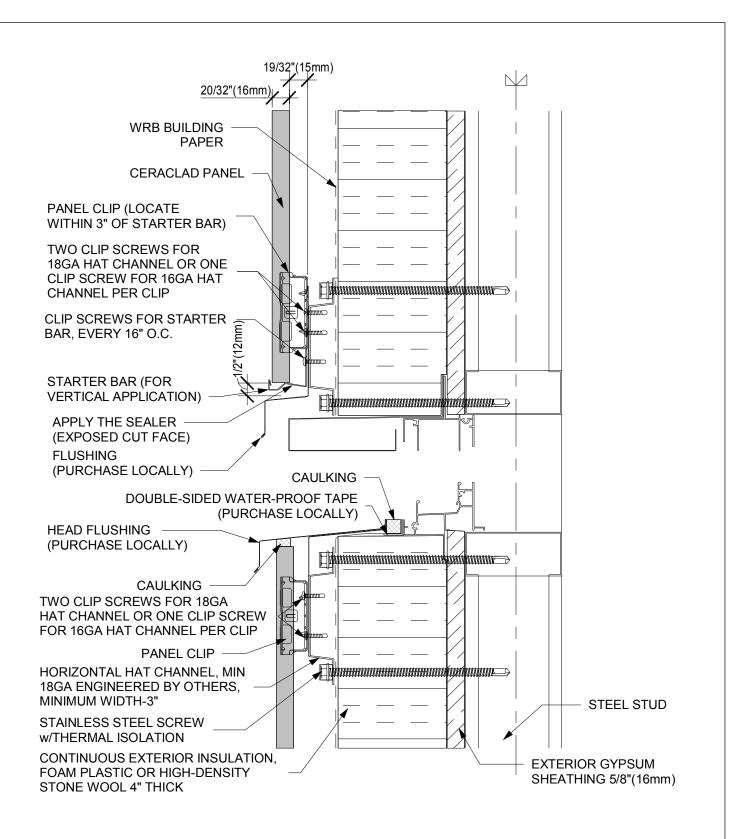
WINDOW AND DOOR **HEAD AND SILL** (STEEL STUD)
