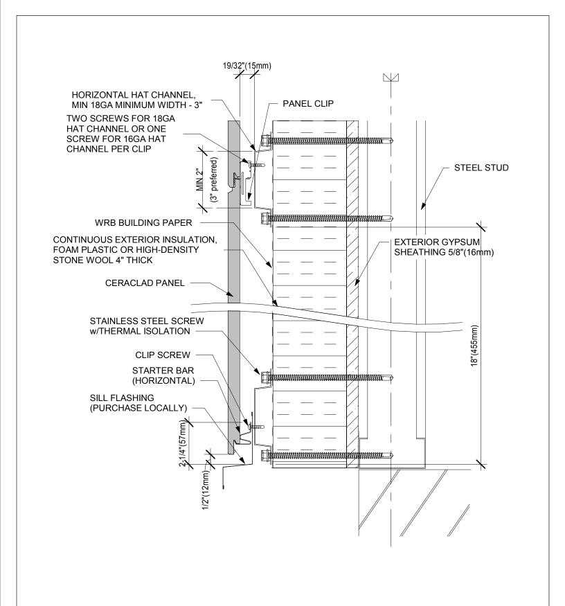
STARTER BAR (STEEL STUD) CERACLAD SIDING PANEL (16mm)
