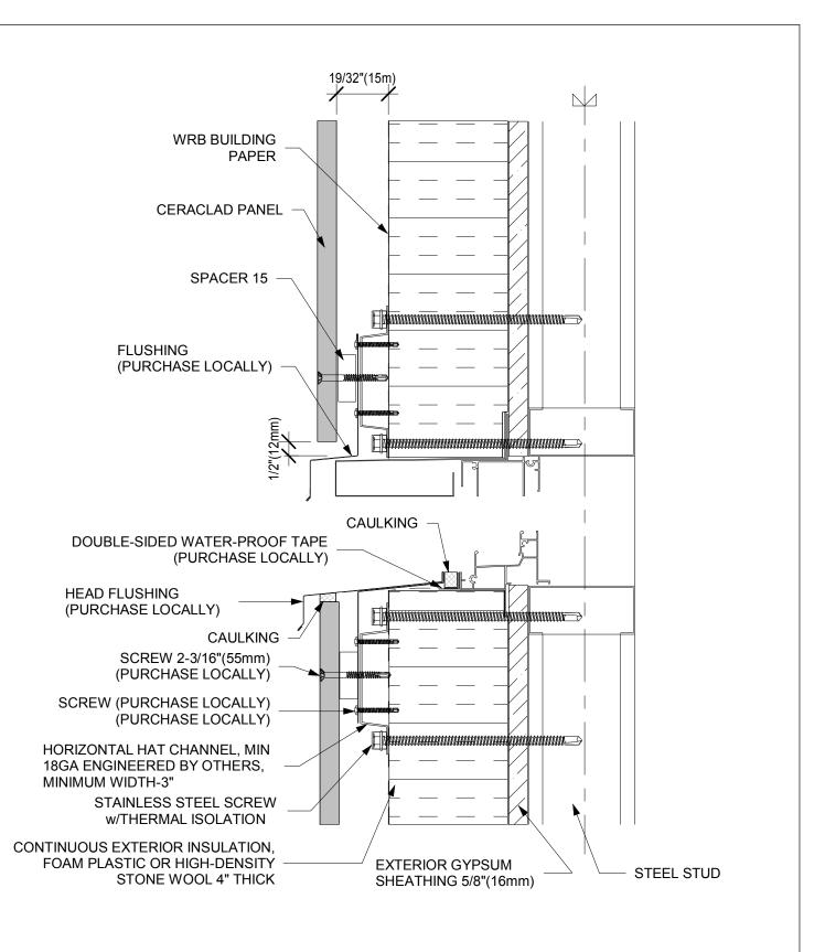
WINDOW AND DOOR HEAD AND SILL(CAULKING) (STEEL STUD)
