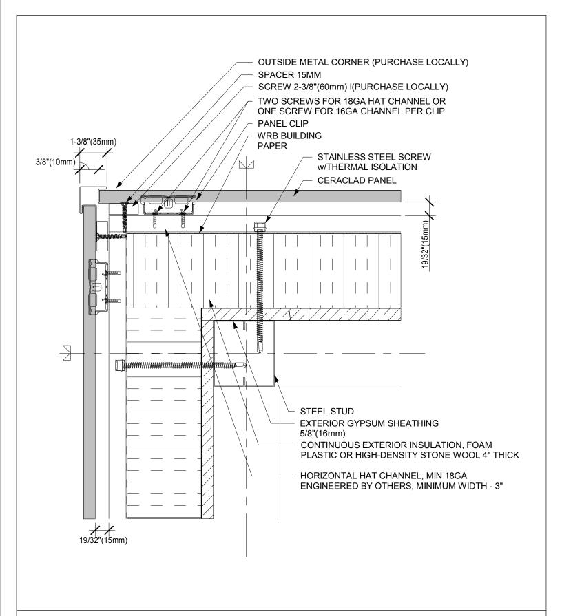
OUTSIDE METAL CORNER (STEEL STUD) CERACLAD SIDING PANEL (16mm)
