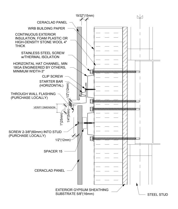
THROUGH WALL FLASHING (STEEL STUD) CERACLAD SIDING PANEL (16mm)
