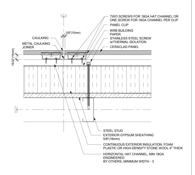
PANEL CAULKING JOINT (STEEL STUD)
