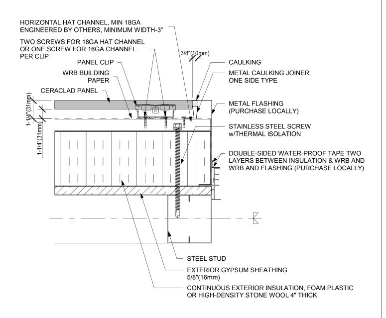
WINDOW AND DOOR JAMB(CAULKING) (STEEL STUD) CERACLAD SIDING PANEL (16mm)
