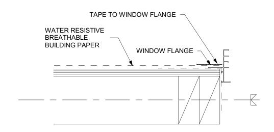
WINDOW AND DOOR JAMB(CAULKING) (STEEL STUD)
