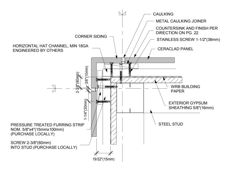
**OUT SIDE PREFORMED** CORNER (STEEL STUD)
