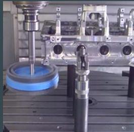
Los cepillos de HEMUSA son usados en el proceso de manufactura de vehículos para tareas como desbarbado o rebabeo de partes de aluminio, remover polvo ultra fino de superficies a pintar, así como para transportar parte de vehículos a través de bandas transportadoras. Los materiales más frecuentemente usados para estos cepillos suelen ser de nylon abrasivo, acero galvanizado, acero inoxidable, latón, bronce fosforado, etcétera, siempre cumpliendo al 100% la tarea para la que fueron diseñados.
