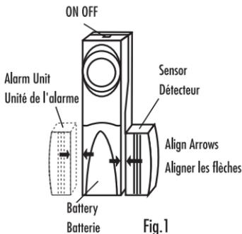
Se fixe sur l'encadrement de la fenêtre ou de la porte et détecte si la porte ou la fenêtre est ouverte. L'alarme se met instantanément en marche... et s'éteint automatiquement après 30 secondes.
