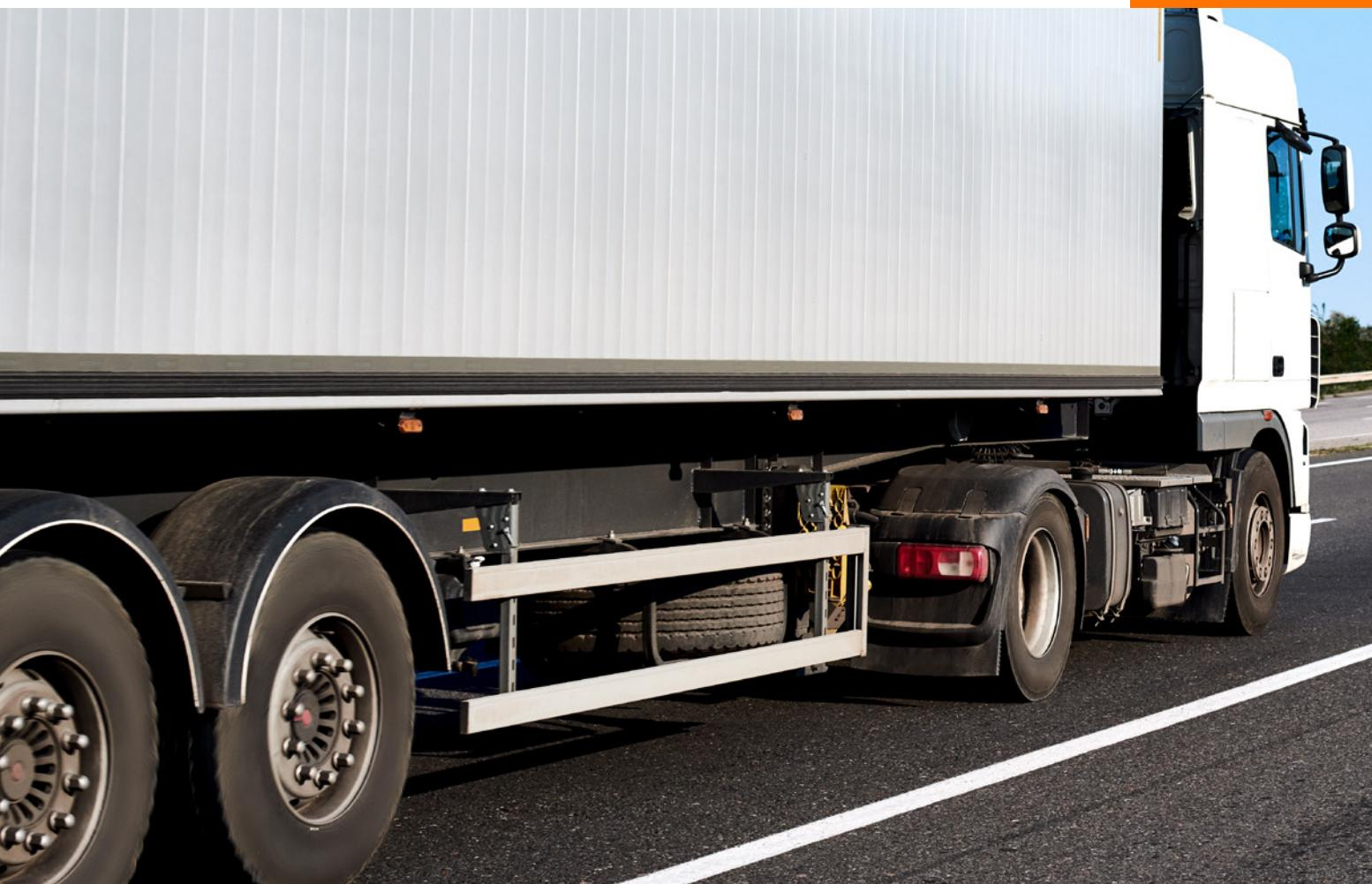
Los **PROTECTORES LATERALES PARA CAMIONES ALUMINA** son dispositivos de seguridad diseñados para proteger la integridad física de los usuarios de las vías como ciclistas, motociclistas y peatones, disminuyendo su riesgo de caída entre los espacios laterales de los ruedas de camiones y semirremolques donde son instalados.
