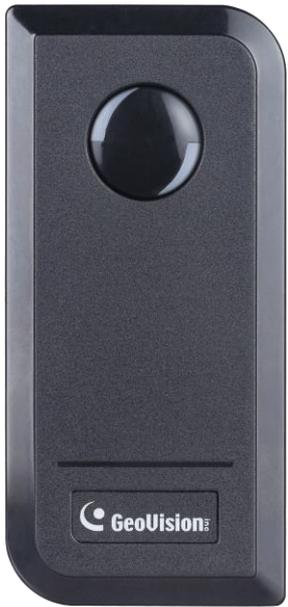
GV-SR1352 是一款雙頻 RFID 讀卡機，可讀取門禁卡並支援 Wiegand 輸出，可以連接到支援 Wiegand 的門禁系統。它的雙頻功能同時支援 125 kHz 和 13.56 MHz，為整合商提供了極大的靈活性，以解決各地的卡片管理問題。GV-SR1352 支援 IP66 防護標準，適合安裝於戶外環境。
