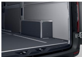
Offerte sur les modèles à pneus simples, la forme carrée avec surface plane de cette couverture de passage de roue offre des possibilités supplémentaires de rangement tout en protégeant le passage de roue.
