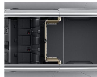
Une cloison de séparation protège la cabine avant de la poussière, de la saleté et du bruit à l'arrière, tout en améliorant la qualité de l'air et en accélérant le temps de chauffage.
