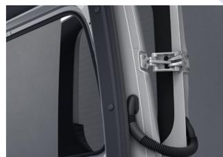
Les portes arrière sont dotées de charnières équipées de mécanismes de verrouillage automatique.
