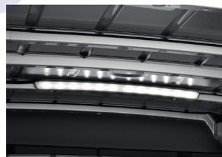
Les bandes d'éclairage à DEL rehaussent la visibilité dans l'espace de chargement.
