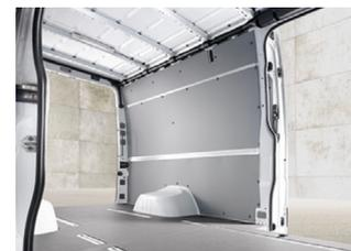
Le revêtement en plastique du plancher permet de réduire le poids jusqu'à 40 % par rapport à un plancher en bois et augmente les possibilités de charges utiles. Ce revêtement est antidérapant et facile à nettoyer, et il protège contre la corrosion.
