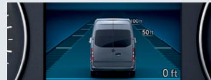
L'**ACTIVE DISTANCE ASSIST DISTRONIC**<sup>5</sup> est un système de régulation de vitesse intelligent qui détecte la circulation et contrôle activement la vitesse pour garder le véhicule à une distance sécuritaire.
