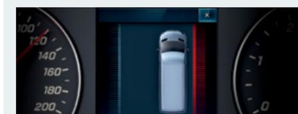
L'**AVERTISSEUR DE FRANCHISSEMENT DE LIGNE**<sup>10</sup> vous envoie des signaux visibles et sonores lorsque le fourgon franchit une voie involontairement. Une caméra située dans le pare-brise assure la surveillance de la route et vous envoie un signal si un franchissement des lignes marquant les voies se produit.
