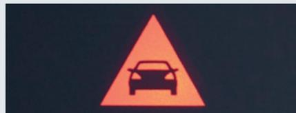
L'**ASSISTANCE ACTIVE DE FREINAGE**<sup>1</sup> est un système avancé qui mesure et détecte la possibilité de collision avec un véhicule devant et envoie des signaux visuels et sonores avant d'appliquer les freins indépendants.
