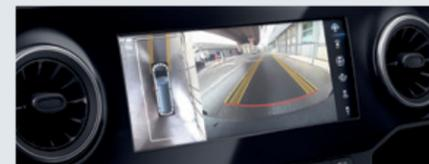
**CAMÉRA 360**<sup>6</sup> Lorsque vous engagez la marche arrière, cette aide visuelle au stationnement utilise quatre caméras numériques pour générer différents points de vue des alentours de votre véhicule et les affiche en temps réel sur l'écran multimédia.
