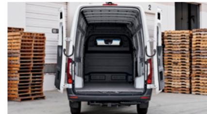
Les portes arrière sont munies de nouvelles charnières équipées de mécanismes de verrou automatique.
