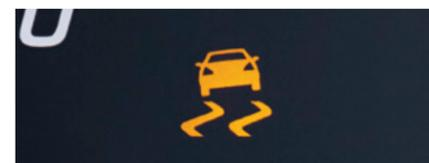
Le **PROGRAMME DE STABILITÉ ÉLECTRONIQUE (ESP)**<sup>9</sup> s'adaptant au poids de la charge de gestion dynamique contribue à garder le contrôle du véhicule et à rehausser la sécurité en appliquant les freins automatiquement pour chacune des roues individuellement et en réduisant la puissance du moteur pour ainsi aider à la stabilisation du véhicule en cas de patinage, de survirage ou de sous-virage.
