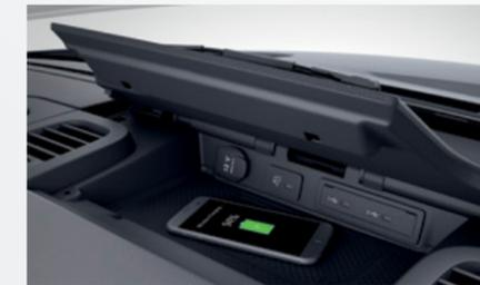
**LES ZONES POUR LA RECHARGE** d'appareils sont placées de façon stratégique dans le tableau de bord et conviennent à la recharge par ports USB-C, sans fil et par alimentation 12 V.
