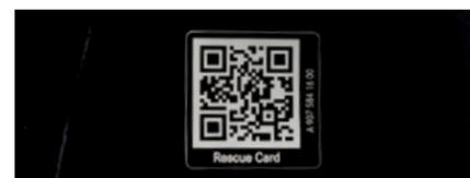
Le **SERVICE RESCUE ASSIST**<sup>8</sup> permet aux premiers répondants sur le site d'un accident de lire un code QR situé dans les fourgons Mercedes-Benz pour ainsi repérer rapidement les batteries, les coussins gonflables et les autres éléments structurels afin de pouvoir procéder à un sauvetage sécuritaire.
