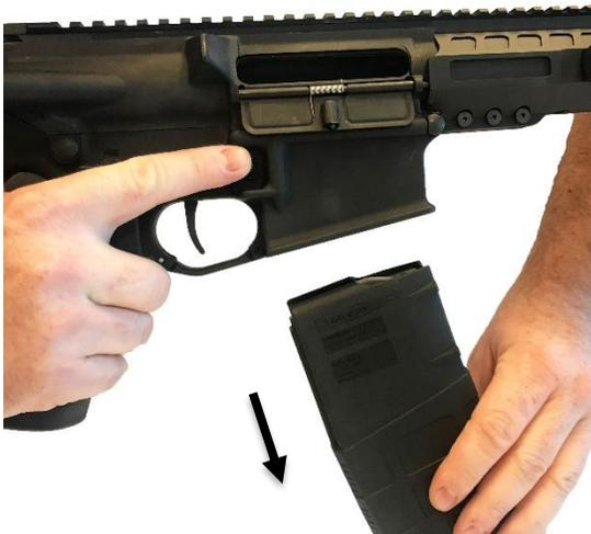
**⚠ CAUTION: THE MAGAZINE WILL FALL FREE WHEN THE MAGAZINE CATCH IS PRESSED. DON'T ALLOW THE MAGAZINE TO FALL ONTO A HARD SURFACE. DOING SO MAY DAMAGE THE MAGAZINE.**
