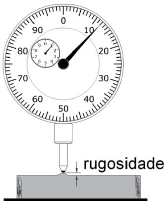
A medida, em polegadas, da rugosidade encontrada na superfície de um bloco metálico, indicada por um relógio comparador em polegada milesimal, conforme ilustrado acima, é
