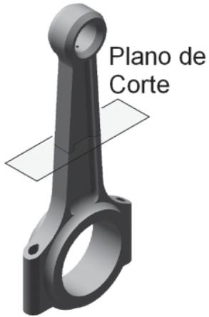
A Figura acima mostra uma biela em vista isométrica no primeiro diedro, onde um plano de corte é usado para representar a seção reta em verdadeira grandeza. A biela possui um canal interno cilíndrico para lubrificação.
