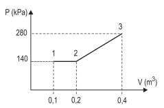
O ar contido em um conjunto cilindro-pistão é submetido ao processo ilustrado no gráfico acima. Durante esse processo, ocorre, inicialmente, uma expansão de 0,1 m³ a 0,2 m³ a pressão constante de 140 kPa, seguida de uma expansão até 0,4 m³, desta vez, com a pressão variando linearmente com o volume, até 280 kPa. O trabalho total associado ao processo, em kJ, corresponde a
