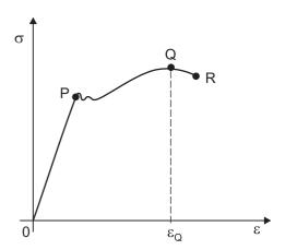
A figura acima mostra o diagrama tensão x deformação, típico de um aço, onde são indicados os pontos O, P, Q e R. Sendo solicitada por tração até o ponto Q, uma barra desse material apresentará uma
