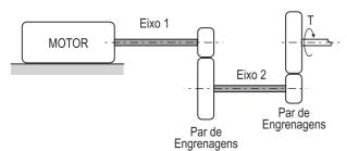
O sistema de acionamento de uma máquina é constituído de um motor elétrico, dois eixos flexíveis e dois pares de engrenagens, como esquematizado na figura acima. Se a máquina exige um torque de acionamento T = 1,5 kN.m, e os dois pares de engrenagens apresentam uma relação de velocidades de 1:5, os torques a serem utilizados no dimensionamento dos eixos 1 e 2, em N.m, são, respectivamente,
