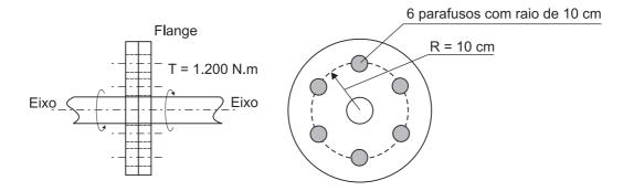
A transmissão de movimento e torque entre dois eixos é realizada por um flange conforme mostrado na figura acima. Considerando os parafusos igualmente espaçados ao longo da circunferência de raio R e os dados fornecidos na figura, a força de corte, em N, a ser suportada por cada parafuso é de
