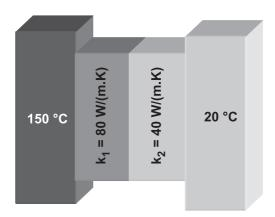
A figura acima apresenta duas barras de materiais diferentes, combinadas em série e montadas entre duas paredes. A área da seção reta de cada barra vale 1 m² e ambas possuem 0,8 m de espessura. Considerando-se as condutividades térmicas apresentadas, a resistência térmica equivalente das duas barras, em K/W, é dada por
