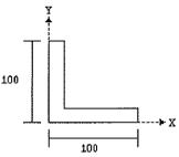
Sabendo que a figura acima representa a seção transversal de uma cantoneira de abas iguais  $(100 \times 100 \times 10 \text{mm})$ , assinale a opção que apresenta a posição do centro de gravidade  $(X_G \text{ e } Y_G)$ , respectivamente), em milímetros, da cantoneira.
