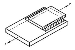
A carga de tração (F) é igual a 140kN e a espessura das chapas é 5mm. Sabendo que a tensão admissível da solda no cisalhamento é igual a 70MPa, qual o comprimento de cada cordão de solda, em mm?
