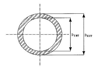
Sabendo que a figura acima representa a seção transversal de um eixo de aço  $(\gamma_{ACO}=8tf/m^3)$  com 10 metros de comprimento e diâmetros interno  $(D_{INT})$  e externo  $(D_{EXT})$ , respectivamente, iguais a 80mm e 100mm, assinale a opção que apresenta o peso do eixo em kgf.
