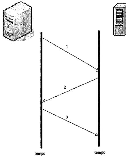
As etapas necessárias para o estabelecimento de uma conexão TCP é denominada handshake de três vias ou 3-way handshake como mostrado na figura acima. Assinale a opção que apresenta a ordem correta dos segmentos trocados no handshake de três vias.
