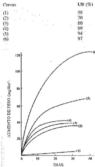
O gráfico acima evidencia a influência de deposição de partículas de NaCl em superfícies de ferro, em diferentes valores de umidade relativa.
