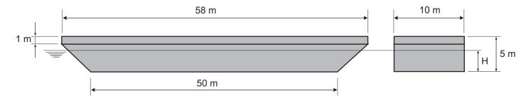
O comprimento, a boca e o pontal da barcaça medem, respectivamente, 58 m, 10 m e 5 m. Se ela flutua, sem banda e sem trim, em água doce ( $\gamma = 1 \text{ t/m}^3$ ), com um deslocamento de 1.590 toneladas, qual o valor, em metros, do calado H?
