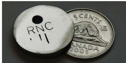
Bouton de ferronickel produit directement à partir du concentré Dumont lors d'essais préliminaires
